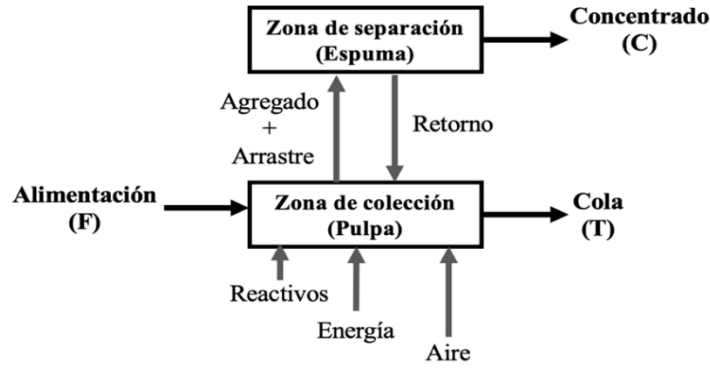
Figura 2.3. Diseño conceptual del proceso de flotación (Modificado de Yianatos & Vinnett, 2015).
