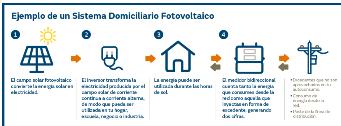
Figura 6: Ejemplo de Sistema Domiciliario Fotovoltaico. (Fuente: Generación Distribuida – Net Billing, Compañía General de Electricidad, 2020)
