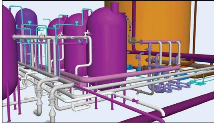
Figura 4: Planta de tratamiento de agua modelada en AutoPIPE.
