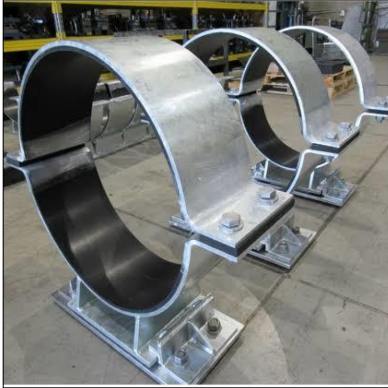
Figura 7: Soporte guía fabricado. (AMSI Engineer Pvt Ltd, 2020)
