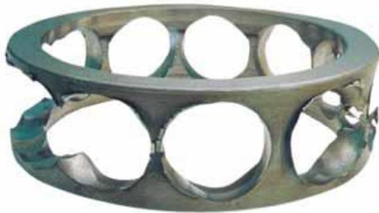
**Figura 6:** Jaula de rodamiento de contacto angular, fracturada y desgastada en los pilares.
