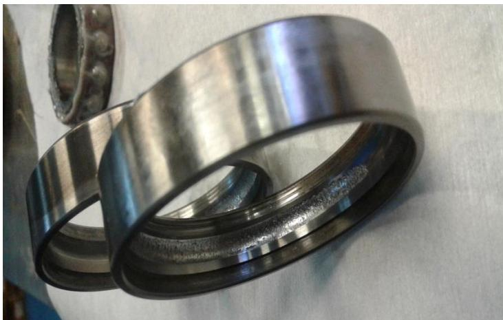
**Foto 7:** Desgaste cubeta exterior rodamiento. Planta N°1 PFalimentos.
