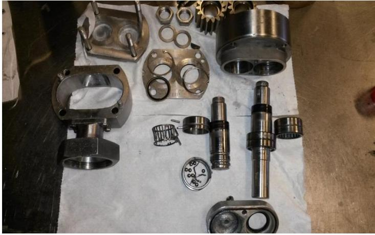
**Foto 3:** Despiece bomba dosificadora. Planta N°1 PF alimentos.
