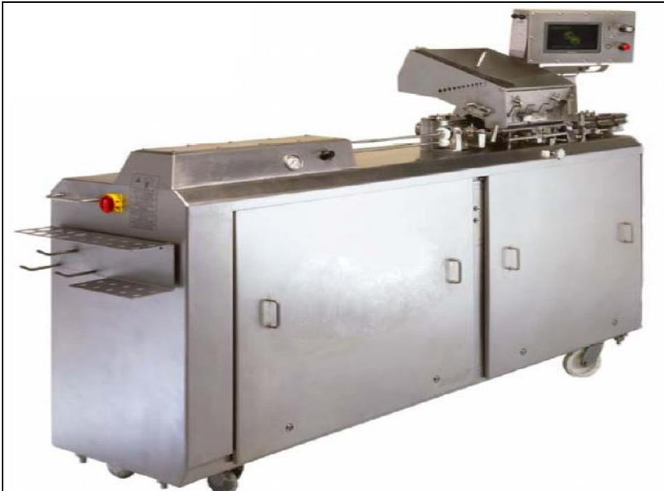
**Figura 15:** Máquina embutidora de vienas NL-17
