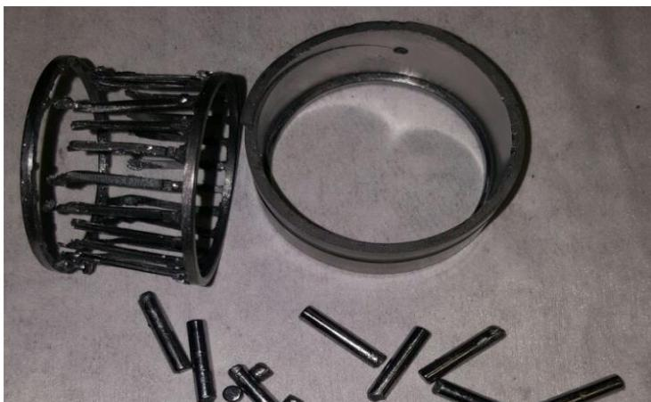
**Foto 8:** Daño en jaula rodamiento. Planta N°1 PF alimentos.
