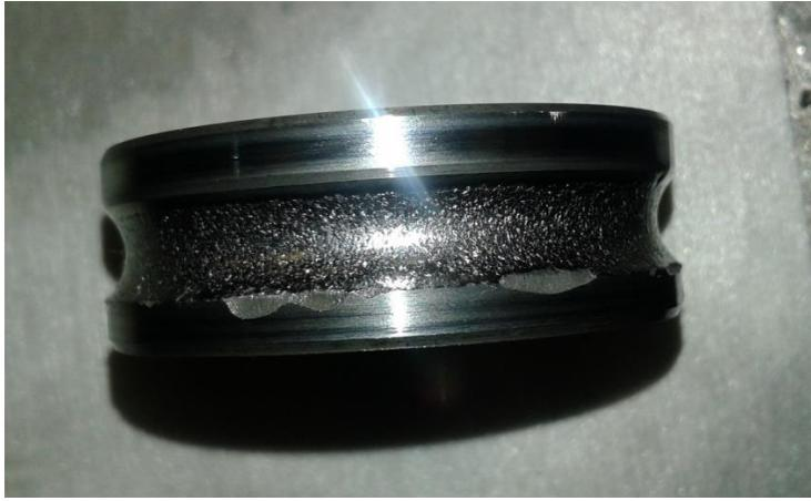
**Foto 6:** Desgaste cubeta interior rodamiento. Planta N°1 PF alimentos.
