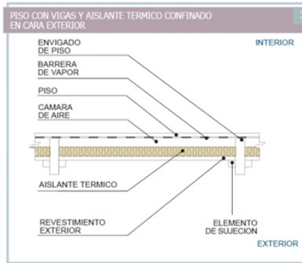
Figura 2.32: Piso con vigas y aislante térmico confinado en cara exterior. Fuente: Acondicionamiento Térmico de Vivienda existente. Camara de la construcción.
