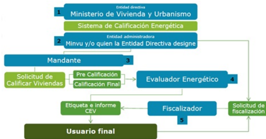
Figura 2.19: Sistema CEV. Fuente: Curso evaluadores energéticos SCEV. MINVU.
