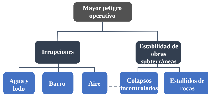
Figura 1. Principales peligros operativos en minería de Caving. Brown (2002) [1].
