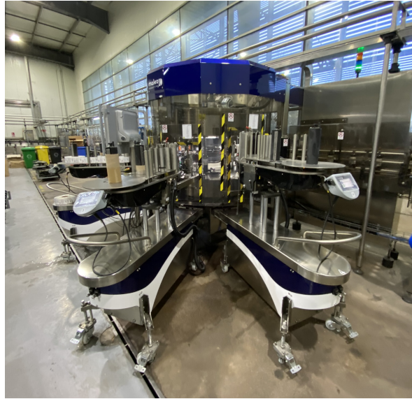
Figura 26: Foto de la máquina etiquetadora MAK 3 -14P Ua14 L4 COC
