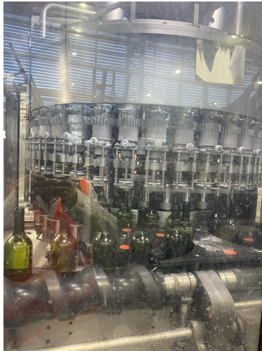
Figura 23: Estación de llenado de la máquina MonoBlock
