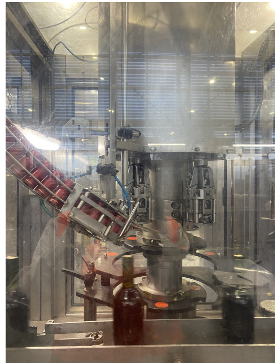
(b) Estación de tapado con screw cap
