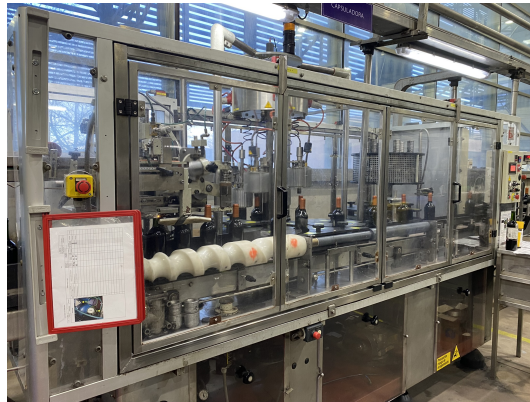
Figura 25: Foto de la máquina capsuladora Poker F4/6
