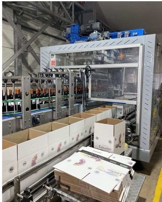
Figura 27: Foto de la máquina encajonadora Accupack 20-3/6
