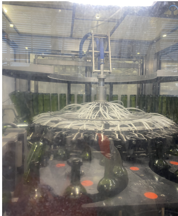
Figura 22: Estación de enjuague de la máquina MonoBlock
