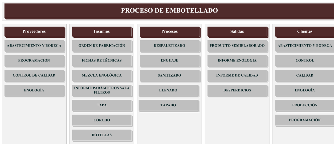
Figura 19: Diagrama SIPOC del proceso de embotellado
