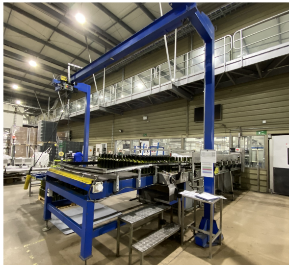
Figura 21: Foto de la despaletizadora de la línea de embotellado 1
