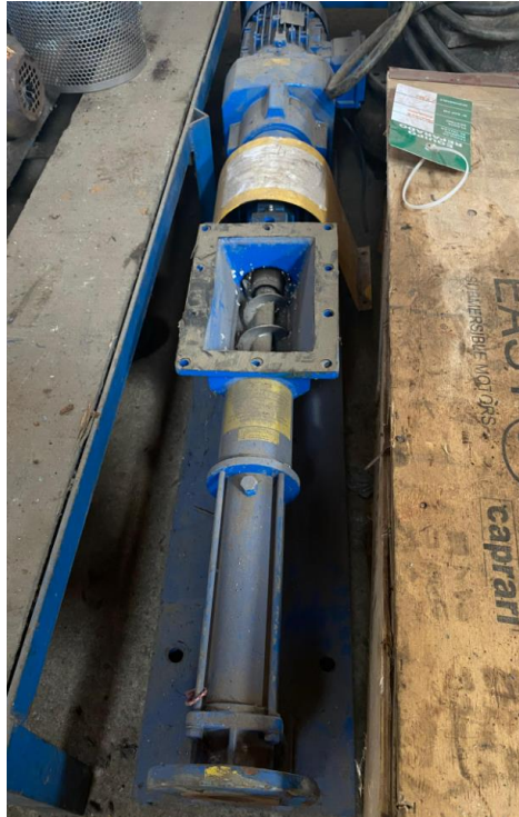
Figura1-12: Bomba de tornillo con una parte del eje helicoidal al descubierto.
