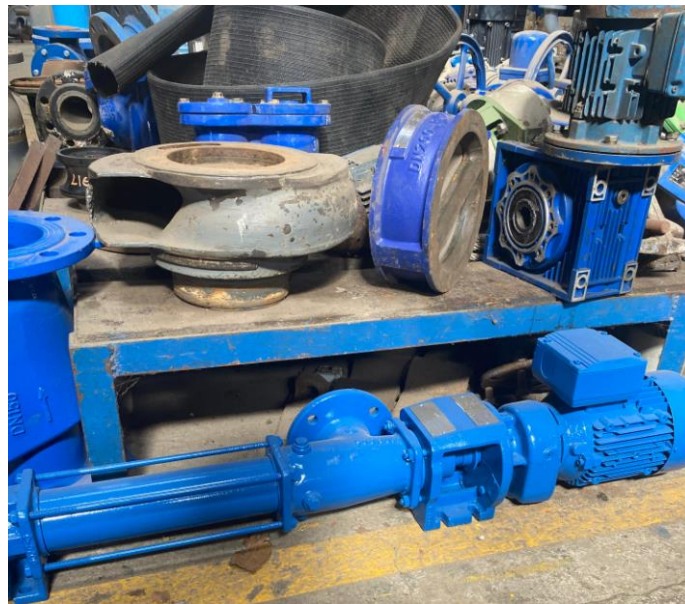
Figura 1-11: Bomba de tornillo en taller de mantenimiento.
