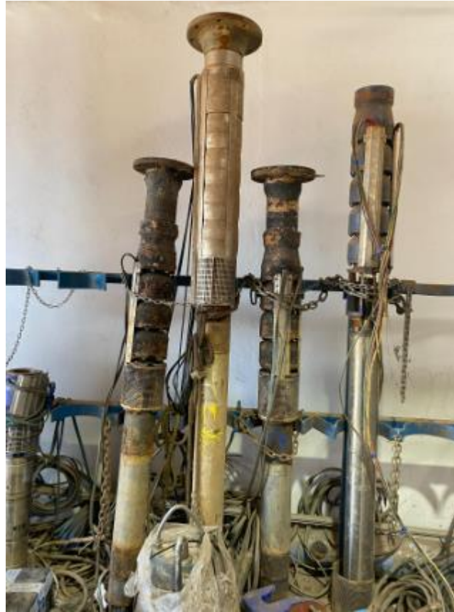
Figura 1-17: Bombas sumergibles de agua potable de distintas dimensiones.
