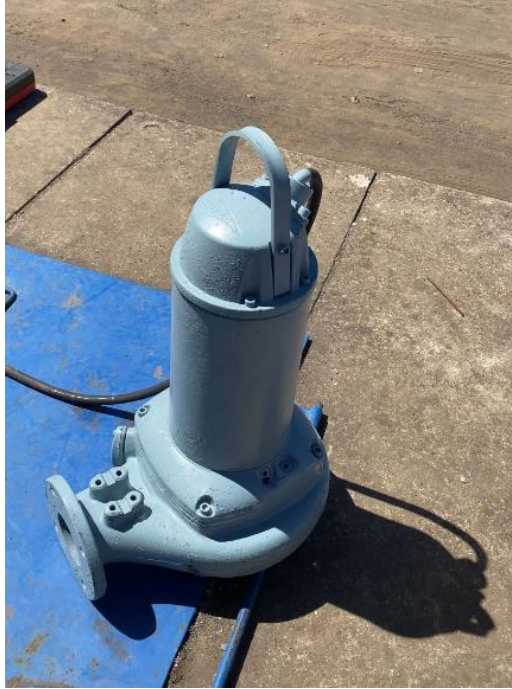
Figura 1-19: Bomba sumergible de planta elevadora de aguas servidas.
