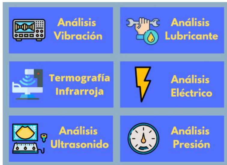
Figura 4: Tipos de mantenimiento basados en la condición
