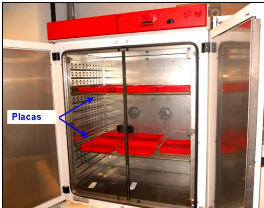
Figura 4-5: Horno Ventilado. Placas Planas de silicona, Ref [15].
