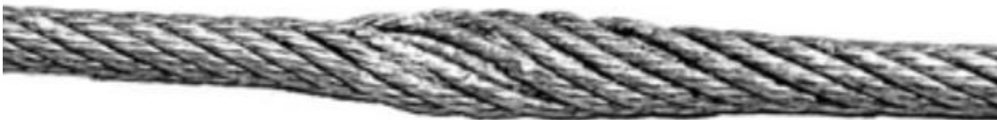
Figura 3.5. Inspección de cables. El cable se ha aplanado. Fuente: ABUS Grúas.
