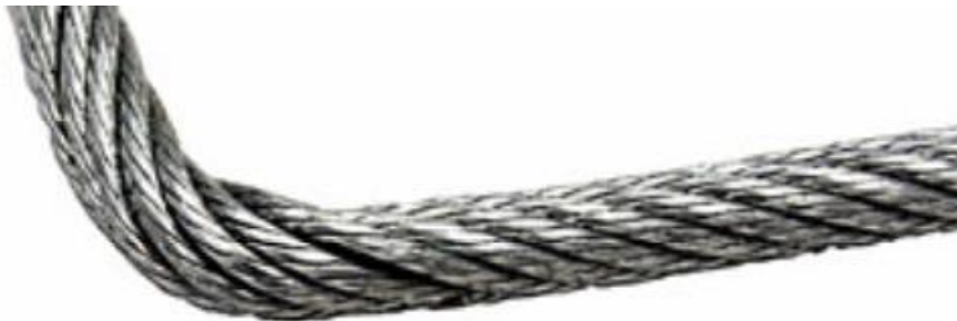
Figura 3.4. Inspección de cables. El cable se ha doblado como consecuencia de una fuerza externa violenta. Fuente: ABUS Grúas.
