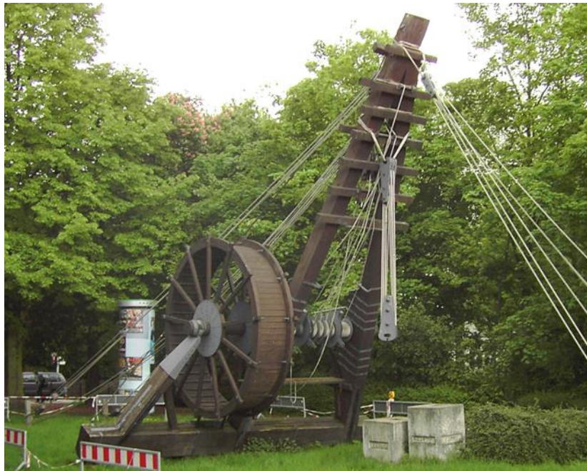
Figura 2.1. Reconstrucción de una grúa de rueda denominada Polyspaston, Alemania.
