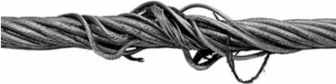
Figura 3.3. Inspección de cables. Se han formados bucles en el cable. Fuente: ABUS Grúas.
