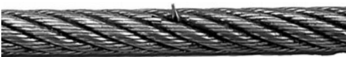
Figura 3.9. Inspección de cables. Alambre roto saliente. Fuente: ABUS Grúas.
