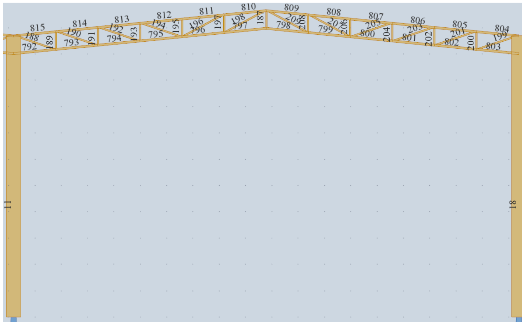
Figura A.8. Vista frontal del galpón industrial. Columnas 11 y 18. Fuente: Elaboración propia. Producido por un producto educativo de Autodesk
