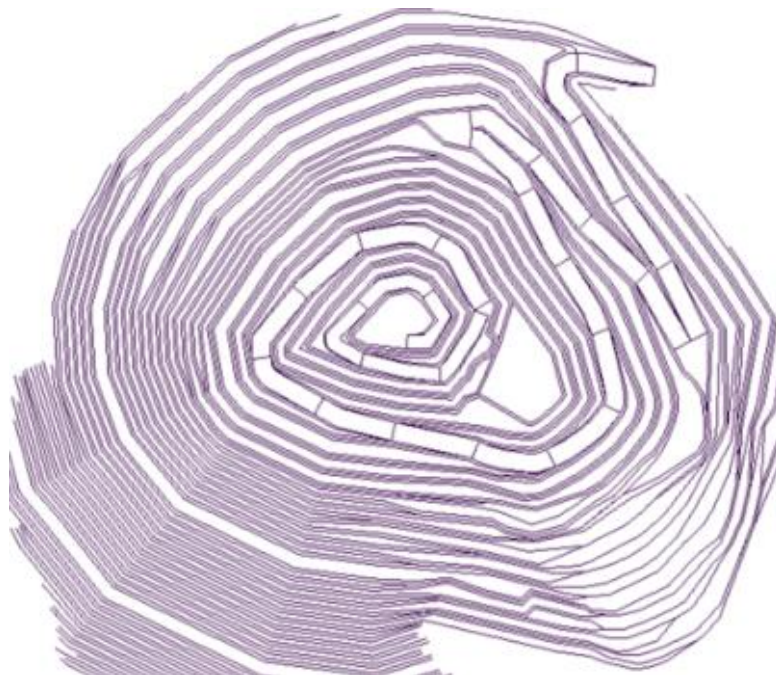
Figura 3: Rampa tipo switchbacks. Fuente: Nube minera (2022)
