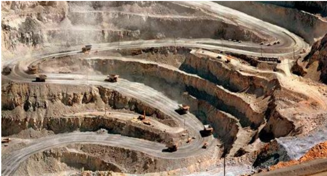
Figura 4: Rampa con Switchbacks. Fuente: CONFEMIN (2022)
