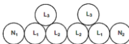
Figura H.52.3 - Configuración especial para 6 cables en paralelo de núcleo simple En trébol
