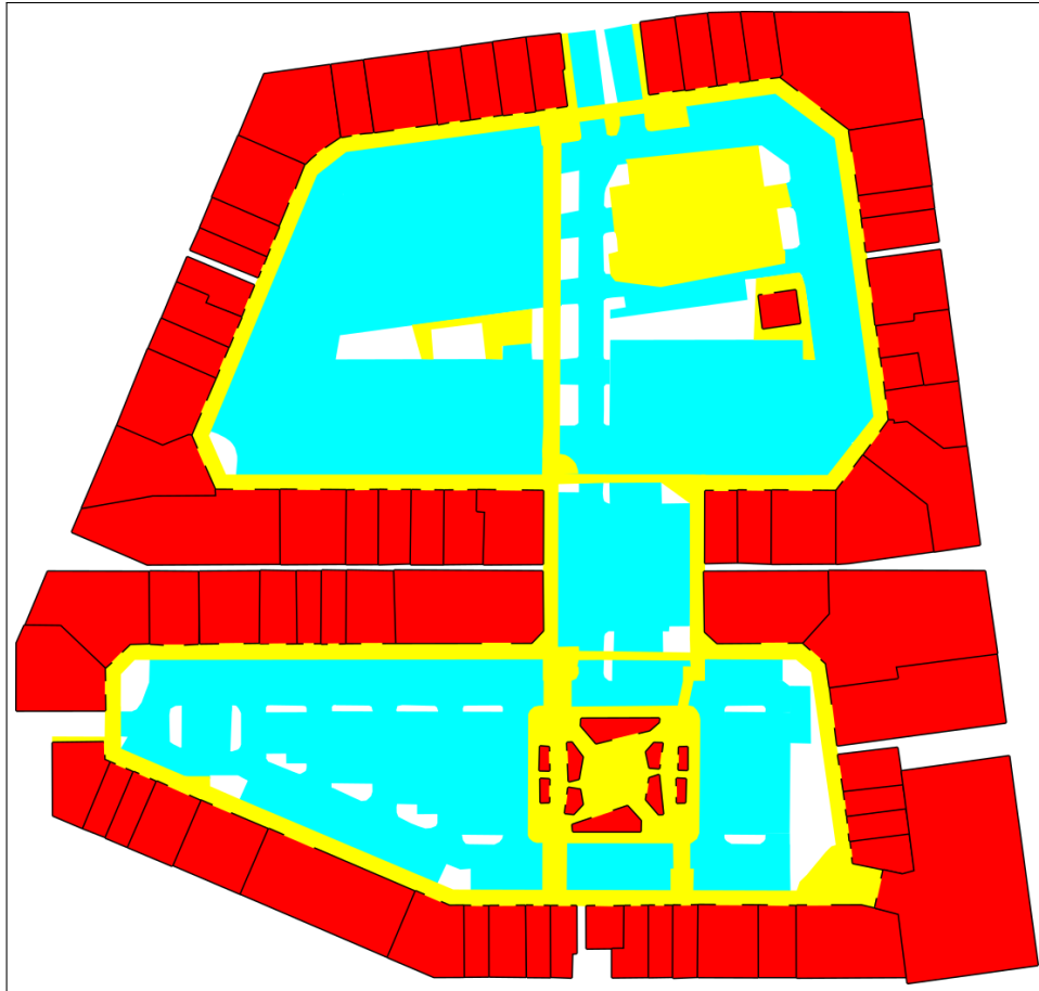
Figura 14: Mapa procesado manualmente, en donde el rojo indica las tiendas, amarillo las zonas transitables, cian los estacionamientos, negro las paredes y blanco las zonas no identificadas.
