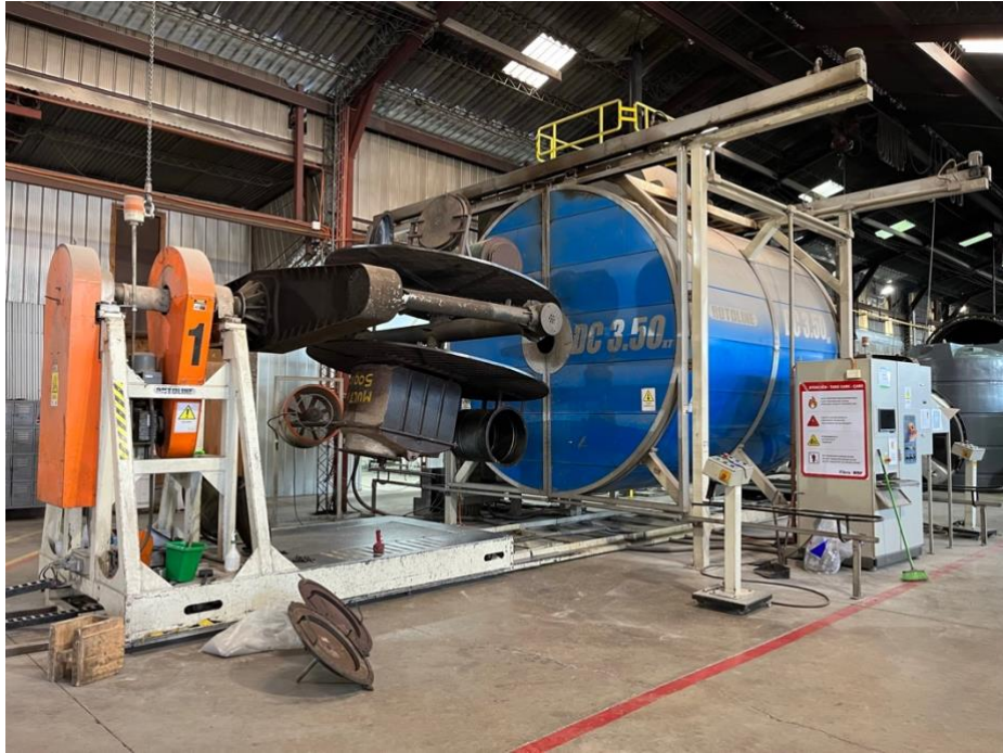
Figura 2.7: Roto moldeadora de tipo horno
