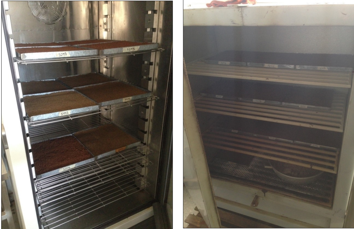
Figura 3-8: Acondicionamiento en Cámara de humedad (izquierda) y Horno (derecha).
