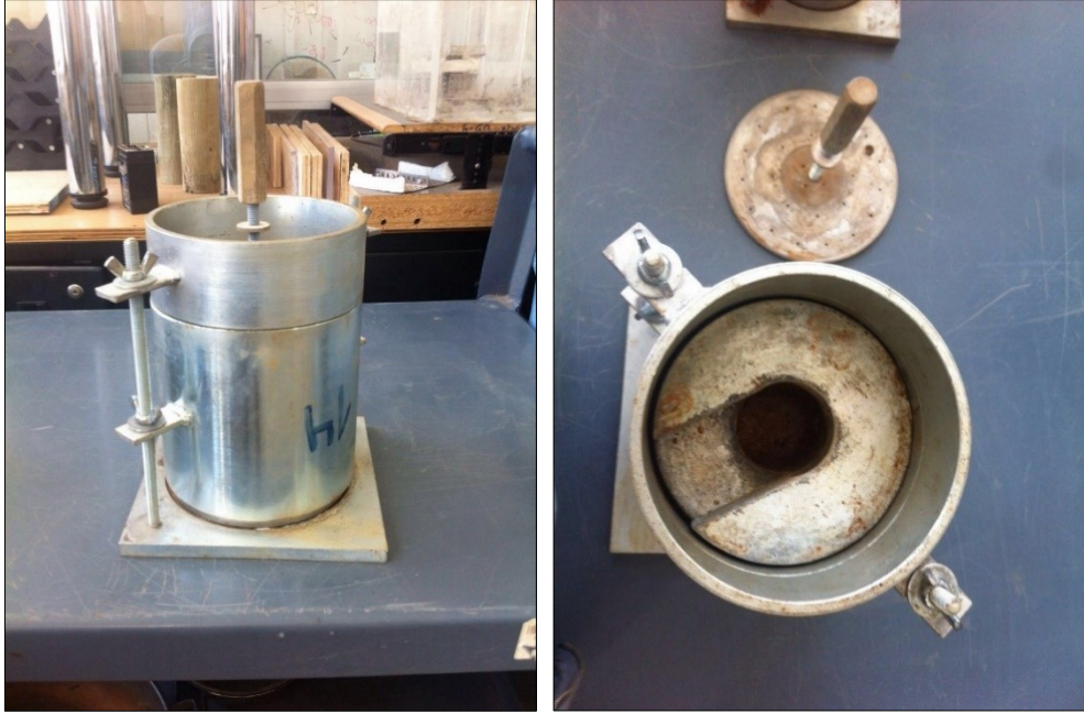
Figura 3-5: Moldes para probetas de ensayos CBR.
