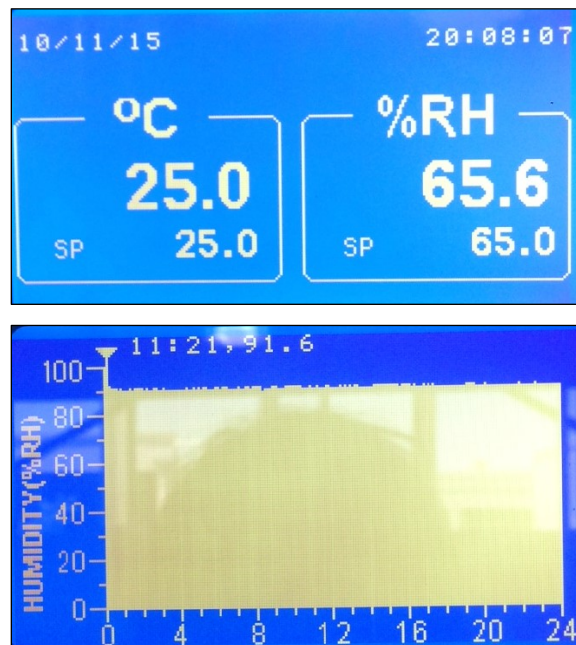
Figura 3-9: Control de humedad y temperatura en Cámara de Humedad.
