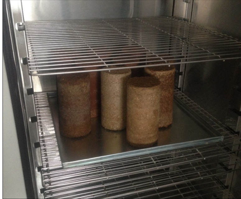
Figura 4-6: Probetas en Cámara de Humedad al término del período de acondicionamiento.
