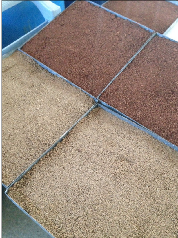
Figura 3-8: Bandejas compactadas listas para acondicionamiento.
