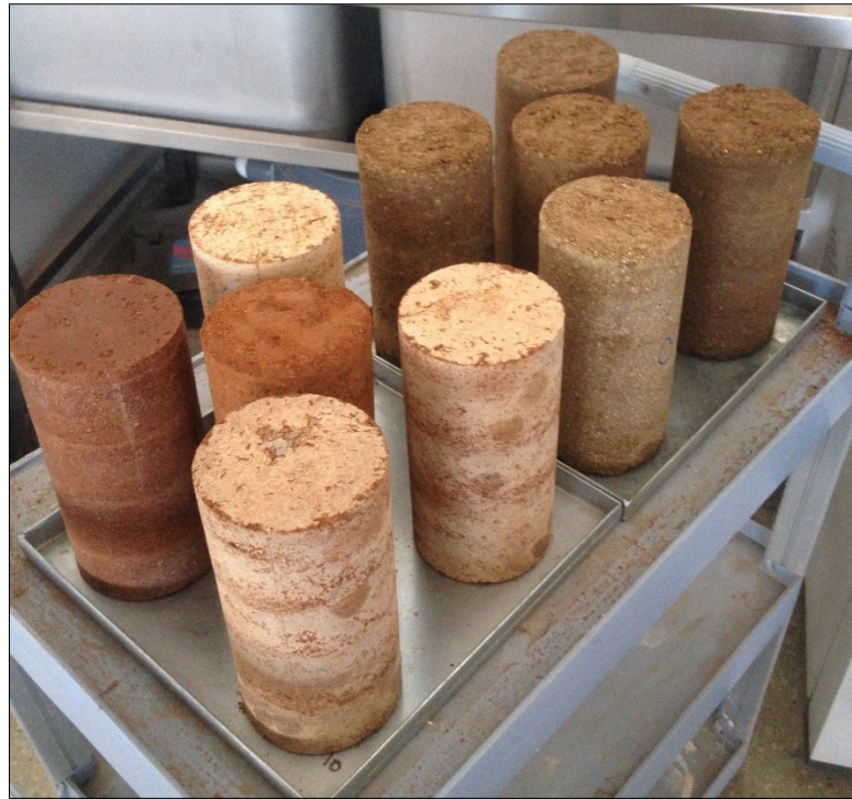
Figura 4-5: Probetas al final del período de secado en Horno.
