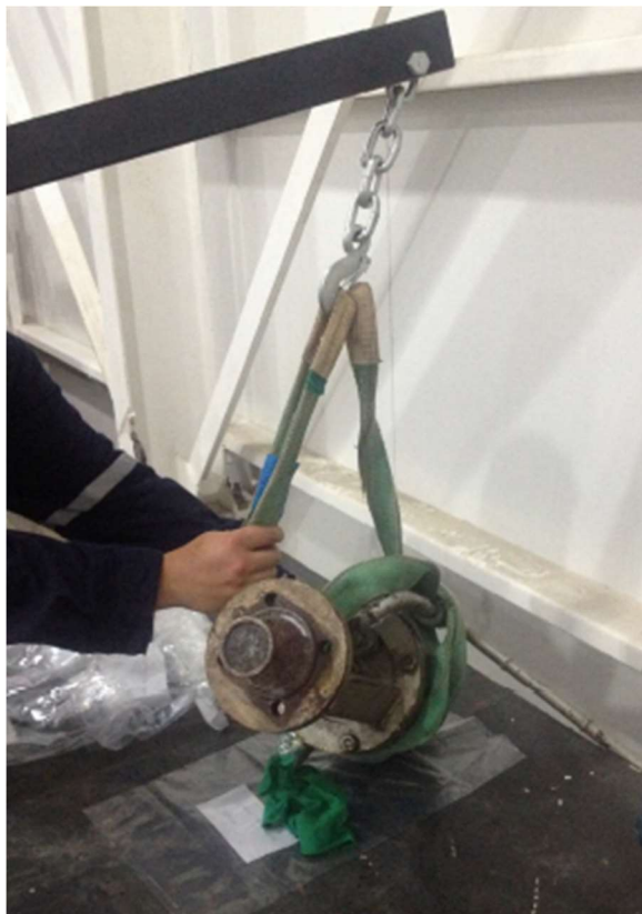
Ilustración 18 - Uso del brazo hidráulico para traslado de elementos pesados
