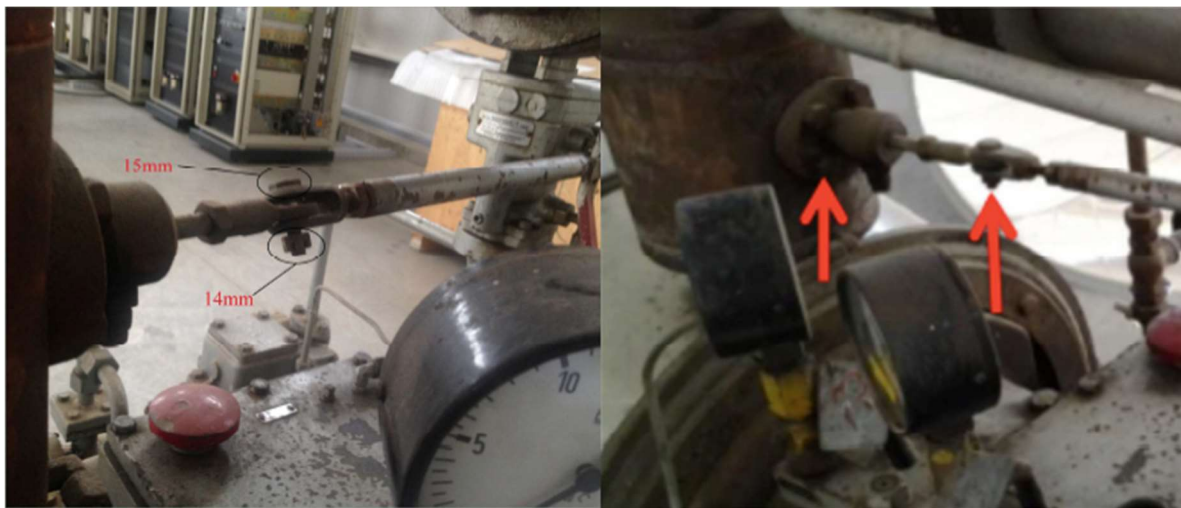
Ilustración 16 – Elemento accionador de la válvula reguladora de velocidad
