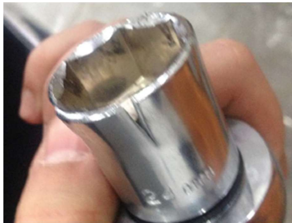
Ilustración 28 - Herramientas en mal estado
