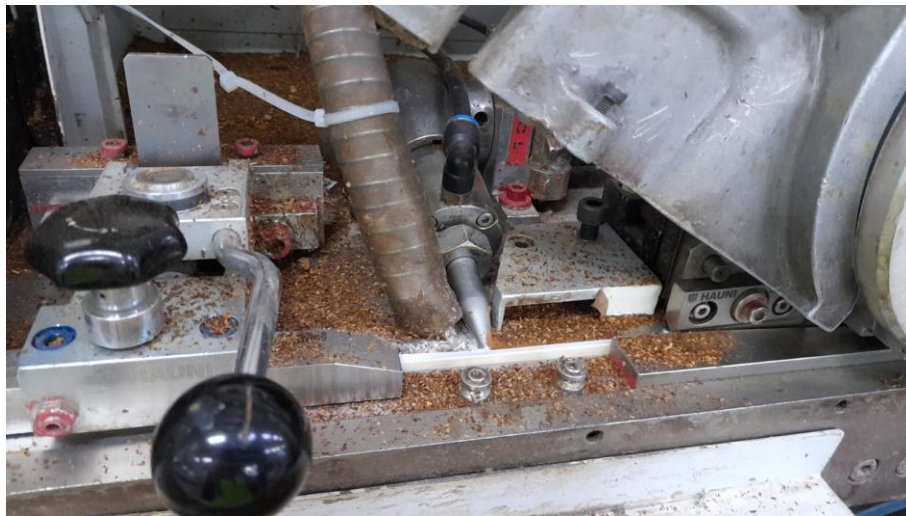
Figura 0-11: Falla Ruptura de Mecha en la Unidad Formadora de Mecha SE. Fuente: Elaboración Propia.
