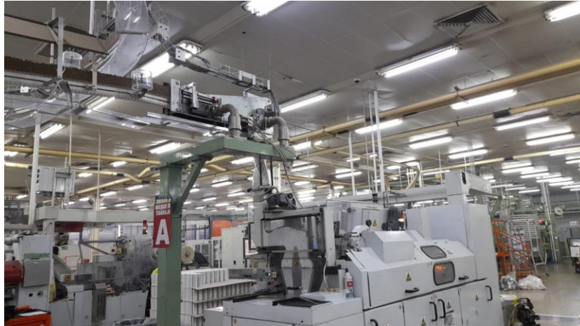
Figura 0-6: B21 y empaquetadora, encargados del transporte de cigarrillos. Fuente: Elaboración propia.
