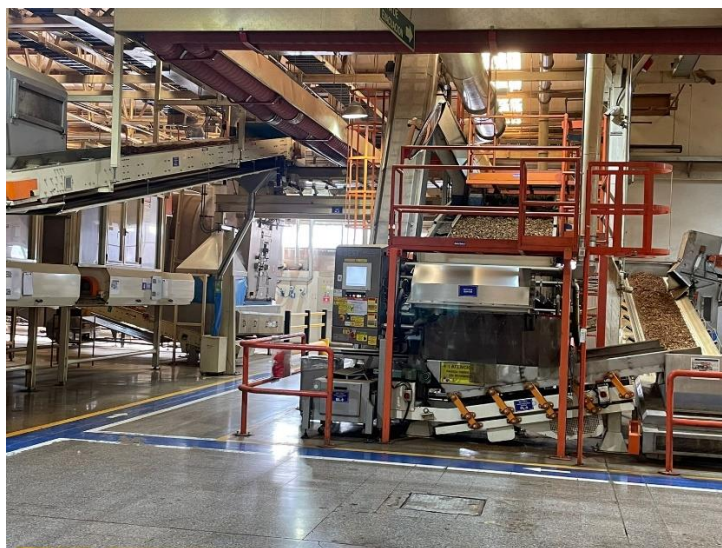
Figura 0-4: Soster, equipo encargado de la preparación del tabaco para luego ser enviado a SMD. Fuente: Elaboración propia.
