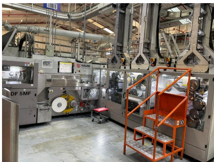
Figura 0-7: KDF encargada de fabricar los filtros, perteneciente a FMD. Fuente: Elaboración propia.
