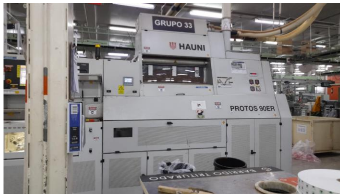
Figura 0-8: Unidad distribuidora de tabaco VE, área SMD. Fuente: Elaboración propia.
