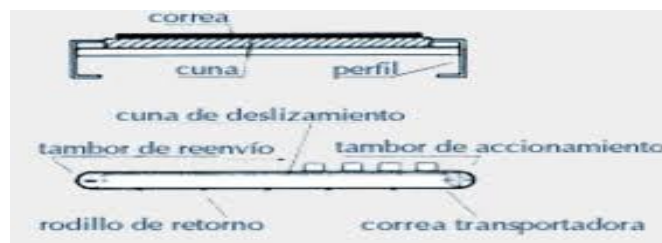
FIGURA 1-17. Trayectoria del desplazamiento
