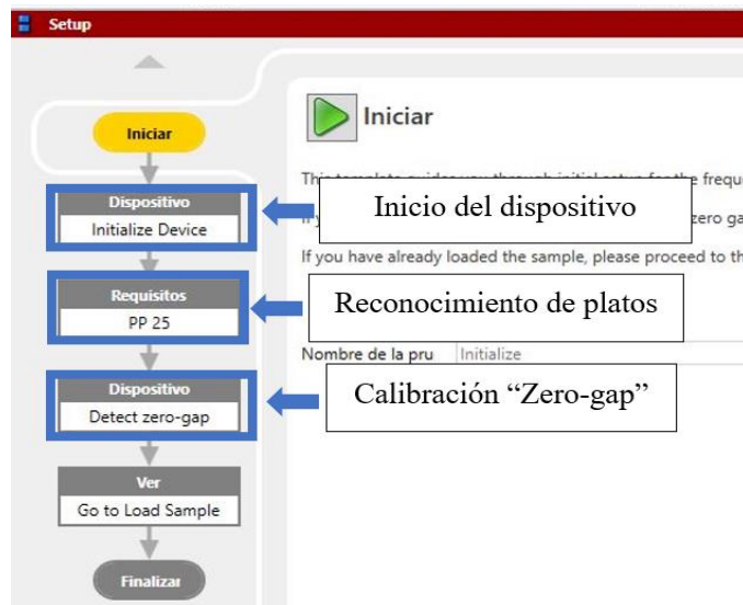
Figura 7.6 Captura del software RheoCompass, inicialización del dispositivo. (Elaboración propia)
