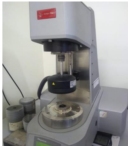
Figura 3.3. Reómetro de corte Dinámico Anton Paar modelo MCR 301, presente en el Laboratorio de Ensaye de Materiales y Control de Obras (LEMCO) de la universidad técnica Federico Santa María. (Elaboración propia)
