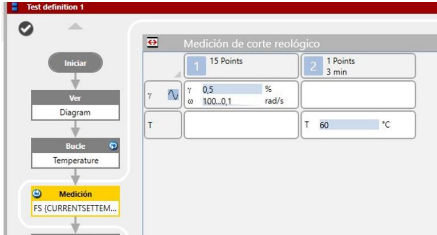
Figura 7.14 Ejemplo de la configuración para el barrido de frecuencias. (Elaboración propia)
