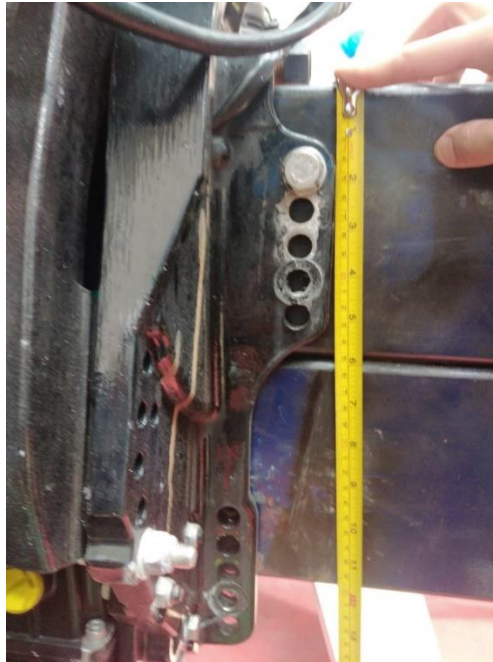
Figura 23 Medidas apoyo soporte de motor Mercury SeaPro 60 HP
