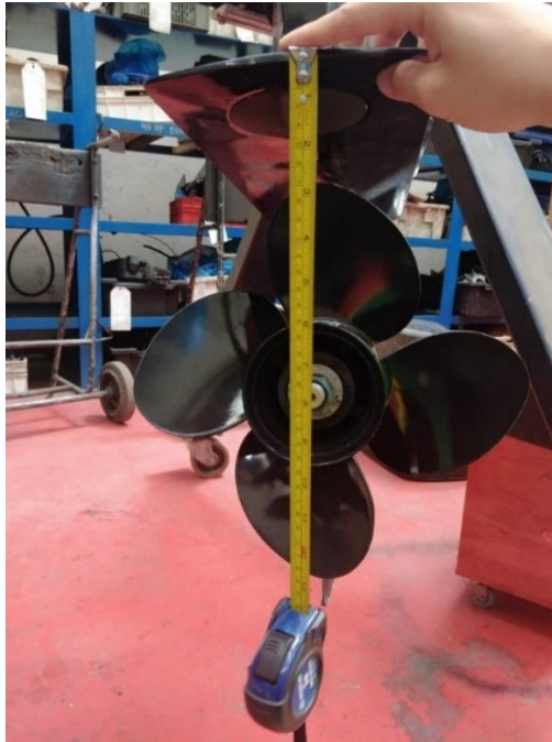
Figura 27 Distancia entre aleta de cavitación y hélice
