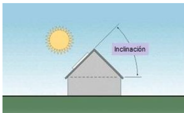
Imagen 2-4. Angulo de inclinación para un sistema fotovoltaico.
