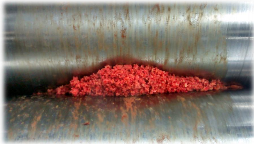
Figura 13: Ingreso materia prima a superficie de secador.
