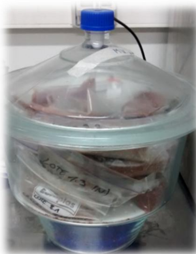
Figura 17: Mantención producto seco en desecador.
