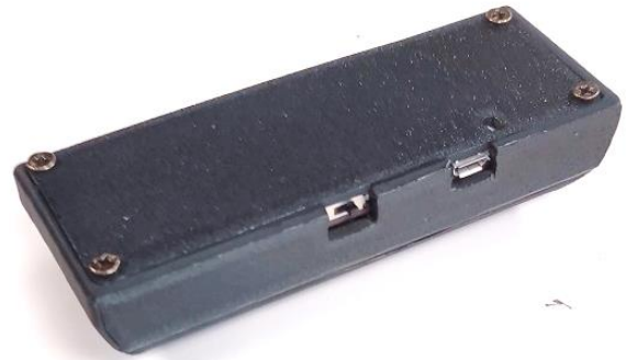
Imagen 40: Impresión PLA de la nueva carcasa con la placa electrónica incluida, Abril 2025
