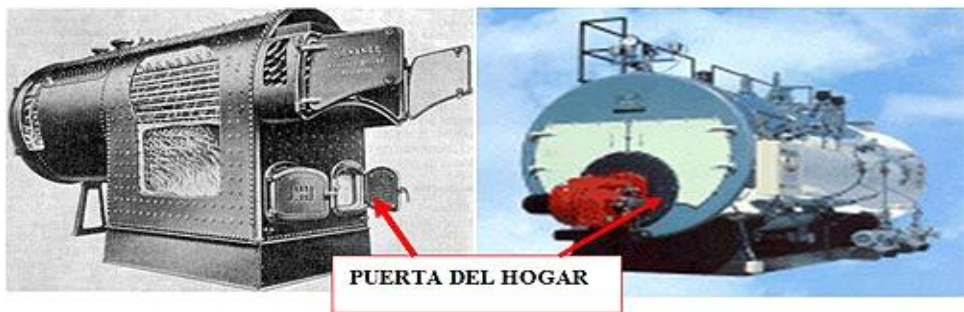
Figura 4: Puerta del hogar de un generador a vapor o caldera
