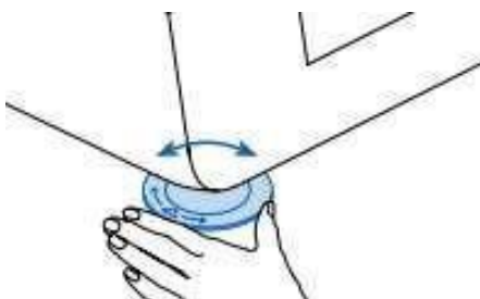
Figura 0-6: Nivelación en cada uno de los pies de la impresora.
