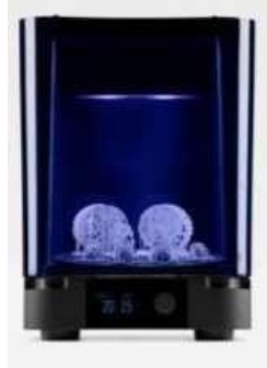
Figura 4-4: La máquina Form Cure es la encargada de lograr las propiedades mecánicas finales de la resina mediante luz ultravioleta que llega a todos los lugares del prototipo.
