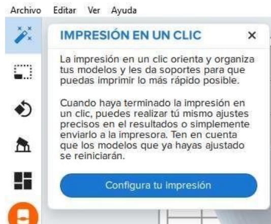
Figura 5-10: Herramienta que genera automáticamente la cantidad necesaria de soportes.
