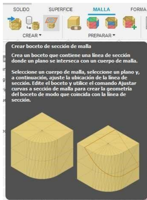
Figura 5-3: Plano que interseca la malla y crea un boceto.
