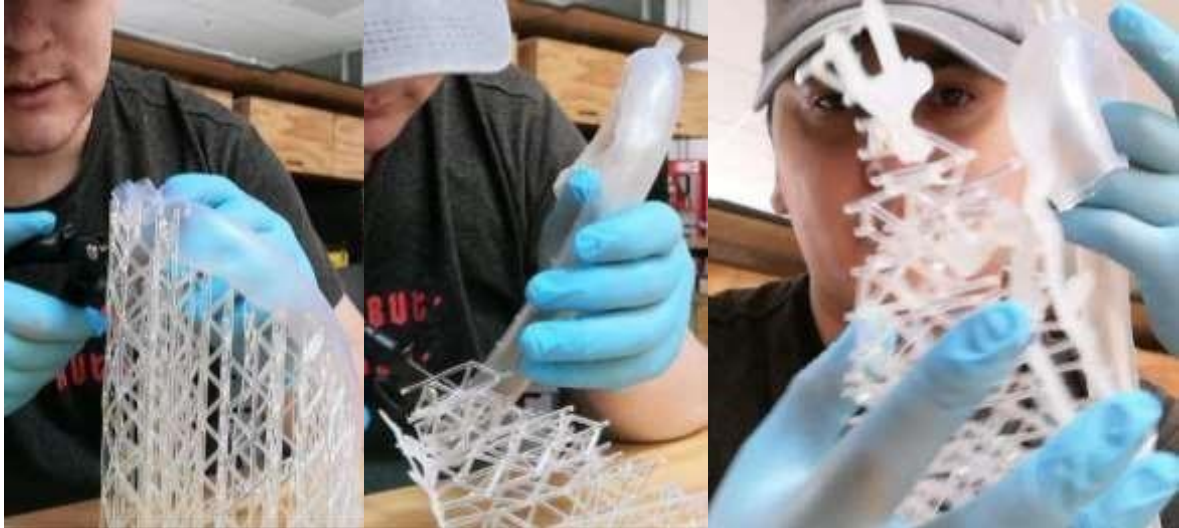
Figura 5-17: Proceso de extracción de soportes.
