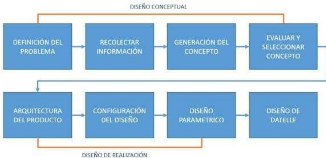
Figura 1-2: Las actividades de diseño que componen las primeras tres fases del proceso de diseño de ingeniería [2].
