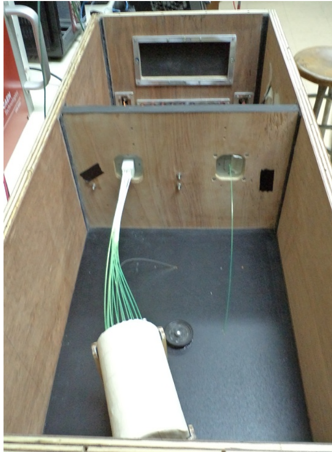
Figura 3.11: Entrega de fotones al MPPC y al PMT.
