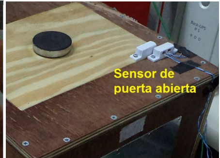
(c) Sensor de puerta abierta instalado en la tapa de la caja
