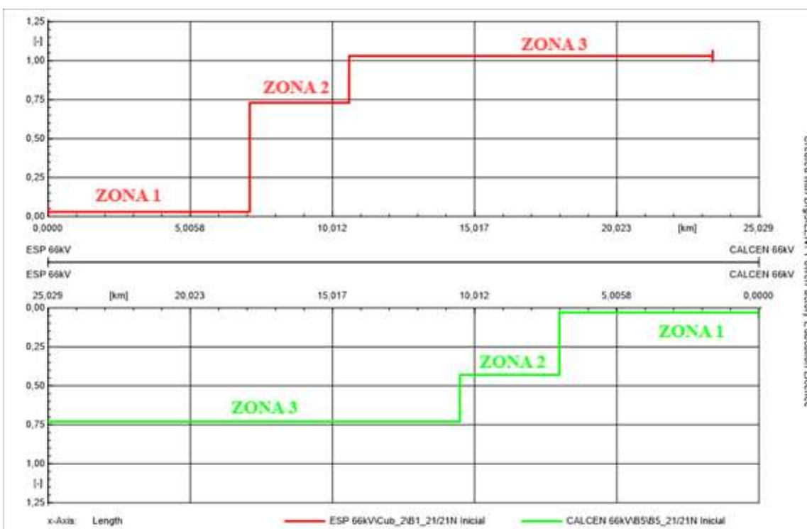
Figura 33: Diagrama tiempo-distancia para el circuito 1 de la línea Esperanza – Calera Centro 60kV simulando fallas monofásicas francas.
