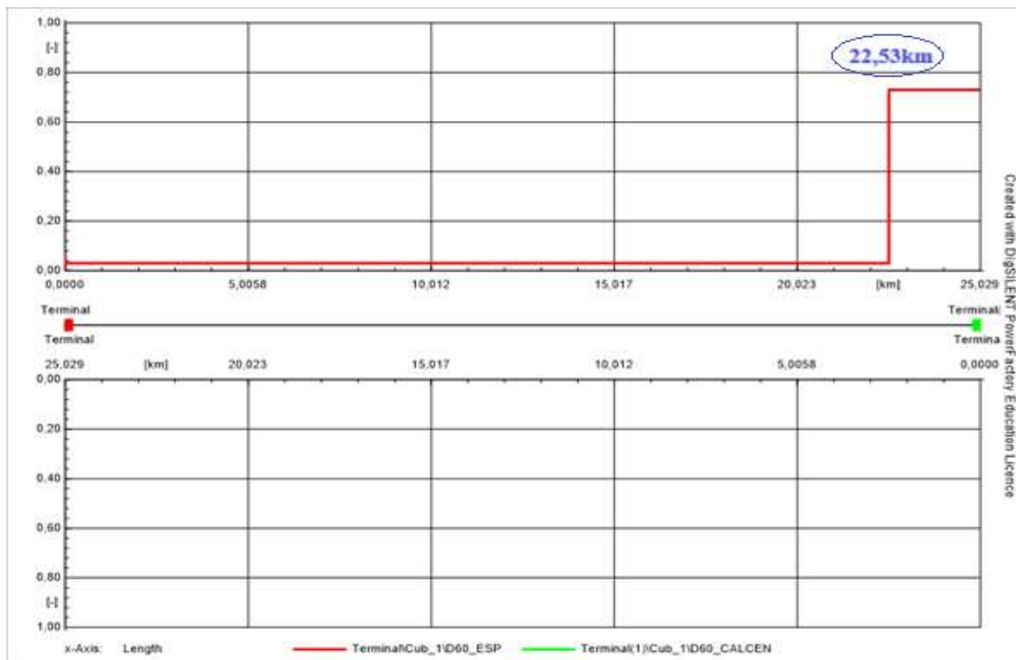
Figura 44: Diagrama tiempo-distancia de circuito 1 de línea Esperanza – Calera Centro 60kV simulando fallas monofásicas francas y circuito 2 desconectado.
