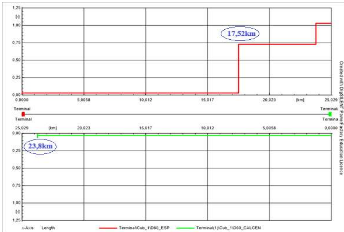
Figura 42: Diagrama tiempo-distancia de circuito 1 de línea Esperanza – Calera Centro 60kV simulando fallas monofásicas francas con ambos circuitos energizados.
