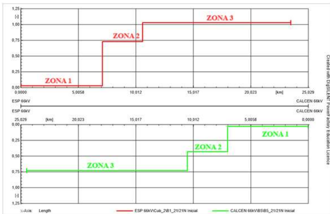
Figura 31: Diagrama tiempo-distancia para el circuito 1 de la línea Esperanza – Calera Centro 60kV simulando fallas trifásicas.
