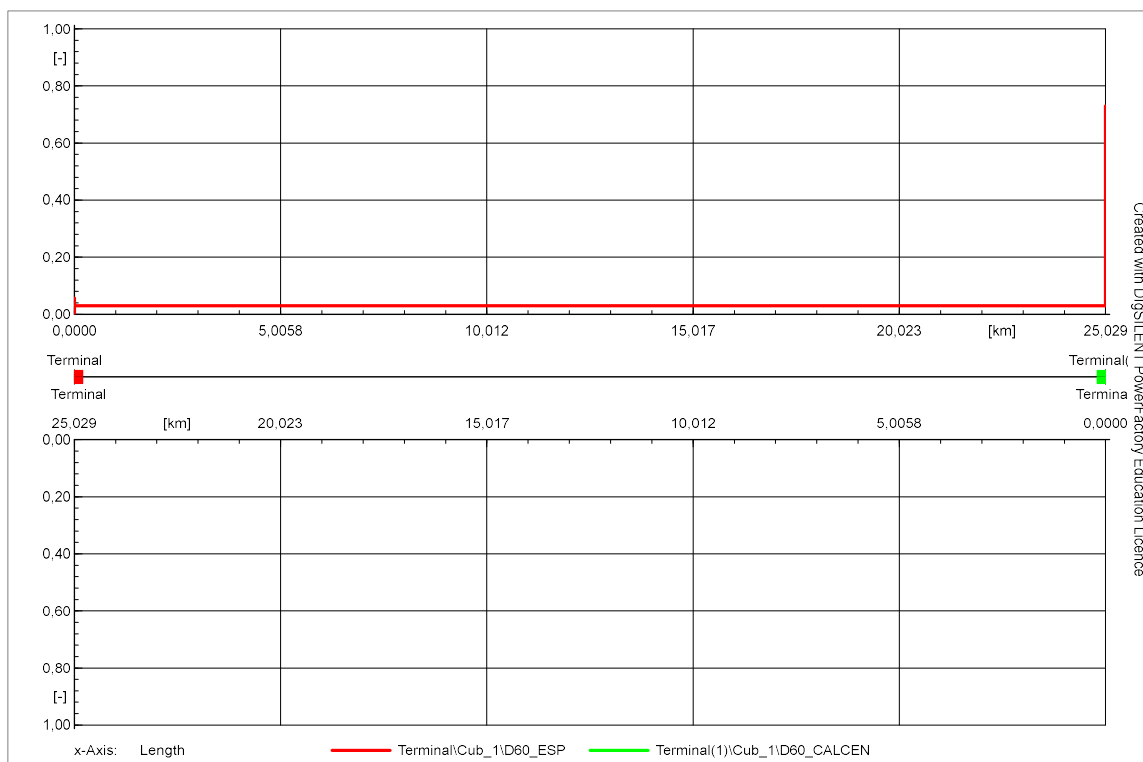
Figura 45: Diagrama tiempo-distancia de circuito 1 de línea Esperanza – Calera Centro 60kV simulando fallas monofásicas con resistencia de falla y circuito 2 desconectado.
