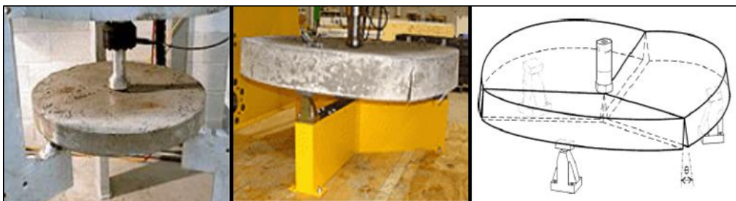
Figura 2.21. Configuración de la prueba ASTM C 1550 de panel redondo y su modo de falla.
