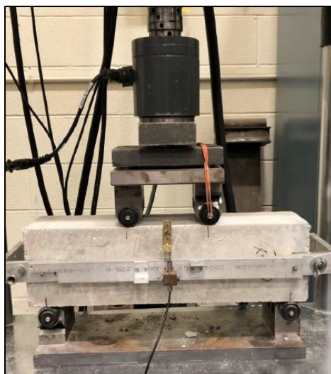
Figura 2.13. Configuración del ensayo ASTM C1609, mostrando el transductor LVDT en la parte superior de la mitad del vano de la viga.
