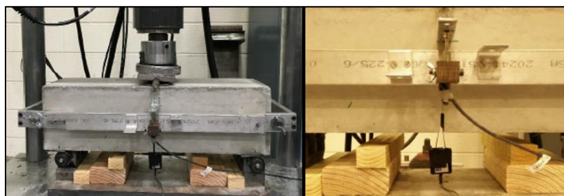
Figura 2.19. Configuración de la norma EN 14651, a la izquierda con un dispositivo de control de deflexiones LVDT, y a la derecha con un dispositivo de control de aperturas de grietas CMOD.
