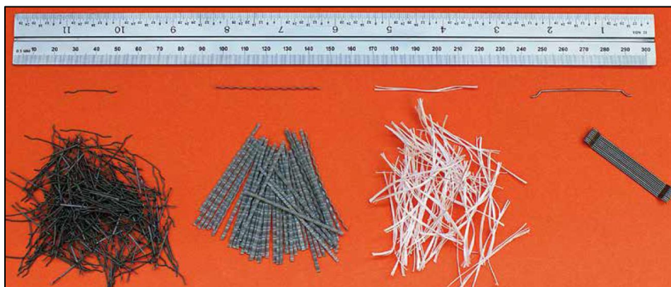
Figura 2.4. Tipos de texturas y formas de fibras. De izquierda a derecha: fibra sintética de extremo enganchado, fibra de acero rizada, fibra sintética recta, fibra de acero de extremo enganchado.
