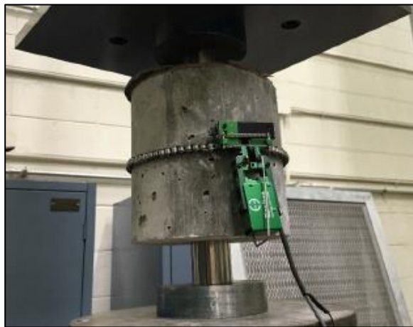
Figura 2.22. Configuración de la Prueba de Barcelona de Doble Punción, utilizando un extensómetro circunferencial para medir su desplazamiento total.
