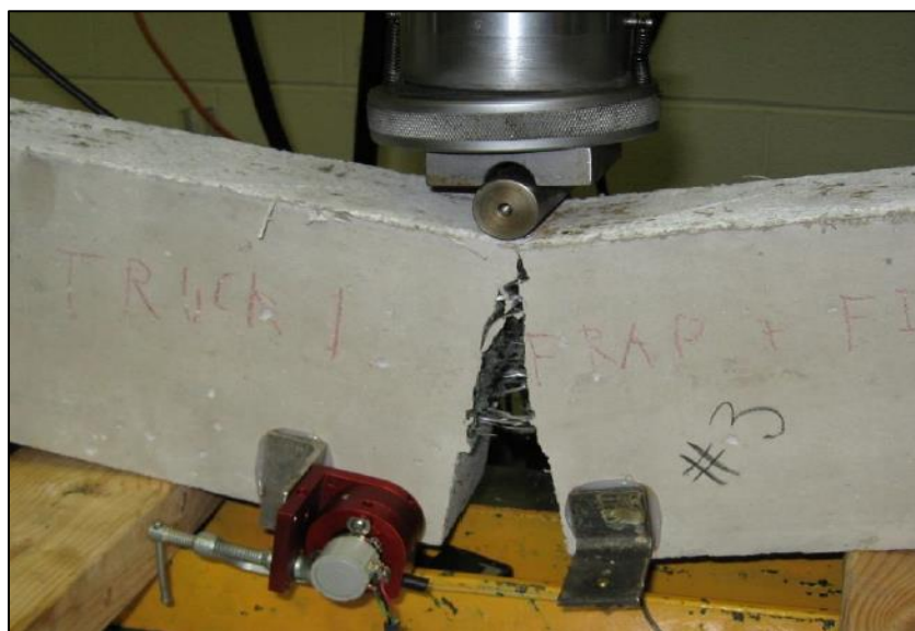
Figura 2.6. Ejemplo de post agrietamiento de una viga de HRF sometida a flexión, usando una dosis de macrofibras sintéticas de 0,43% [Roesler et al., 2019].
