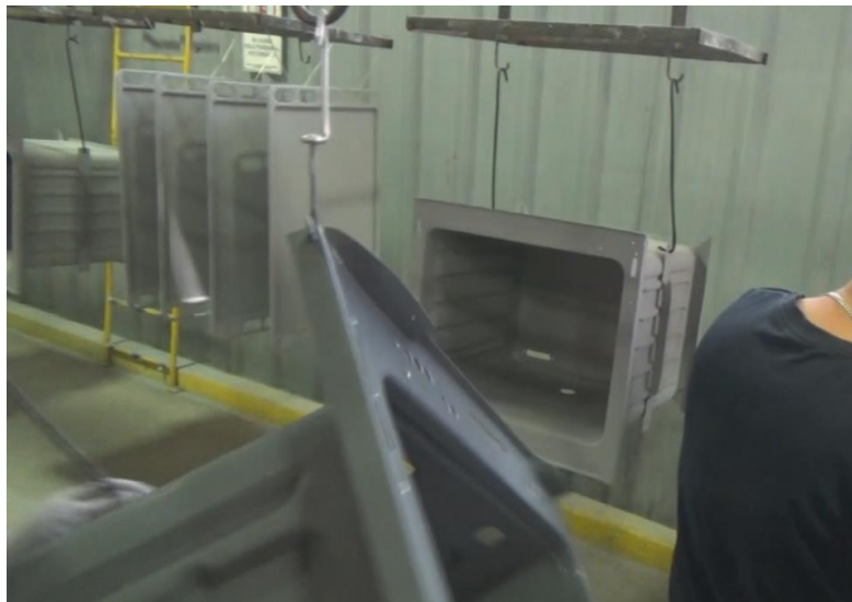
Figura 15: Módulos transportadores de las piezas de cocina. Fuente: Fotografía tomada en la línea de esmaltado.
