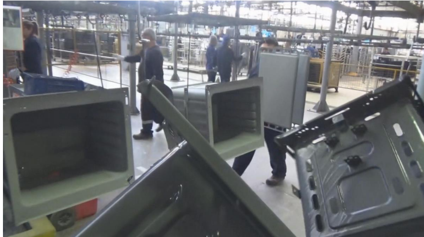
Figura 14: Piezas colgadas en la cadena transportadora. Fuente: Fotografía tomada en la línea de esmaltado.
