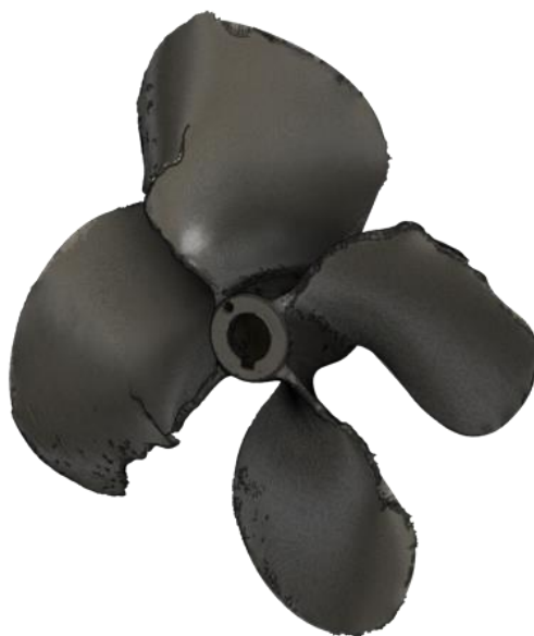
Figura 16. Modelo tridimensional obtenido a partir del escaneo de la hélice utilizada como referencia geométrica. Fuente: Elaboración propia a partir del levantamiento realizado en OK-SHIP, 2026.
