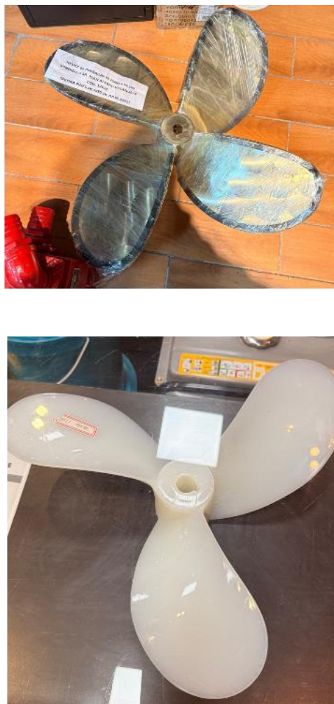
Figura 11. Ejemplos visuales de una hélice metálica de cuatro palas y una hélice polimérica de tres palas. Fuente: Elaboración propia, 2026.
