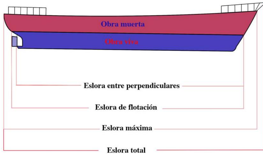
Figura 9. Referencias geométricas de eslora y zonas de obra viva y obra muerta de una embarcación. Fuente: Sailandtrip, 2026 .
