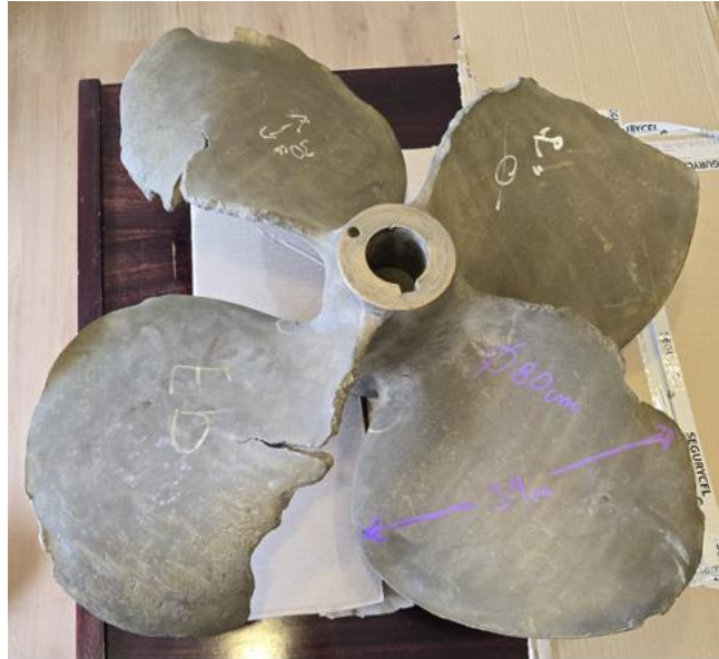
Figura 7. Hélice metálica utilizada para escaneo con daño y deformación visible en sus palas Fuente: Elaboración propia, 2026.
