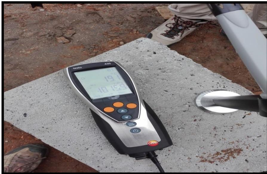
Figura n°8: Instrumento de medición de temperatura Anemómetro térmico
