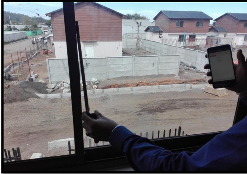
Figura n°12: Anemómetro midiendo infiltraciones en ventanas
