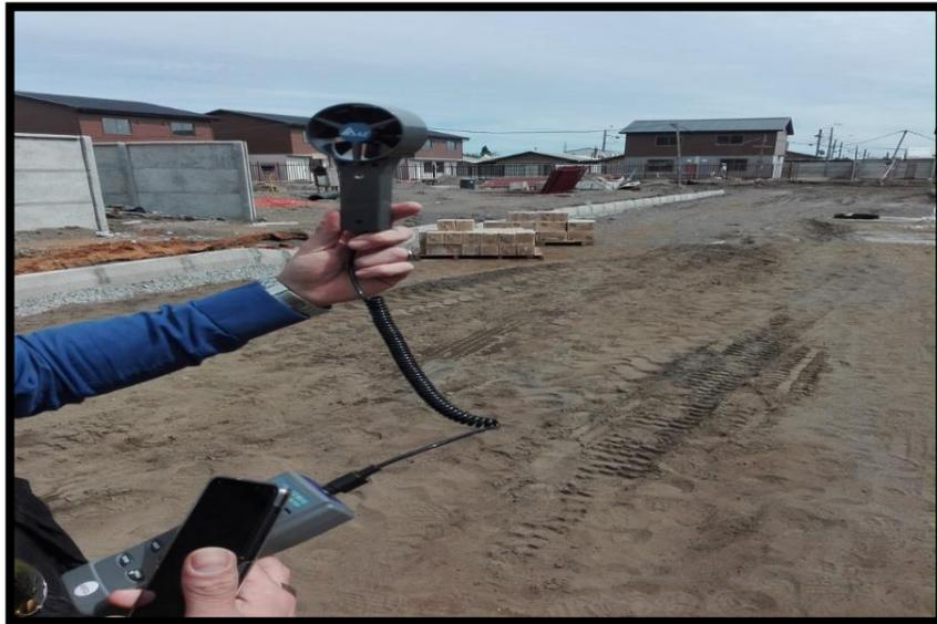
Figura n°9: Termo Anemómetro registrando velocidad de aire
