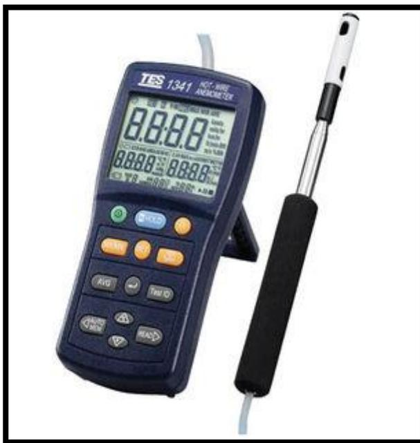
Figura n°19: Anemómetro con filamento caliente
