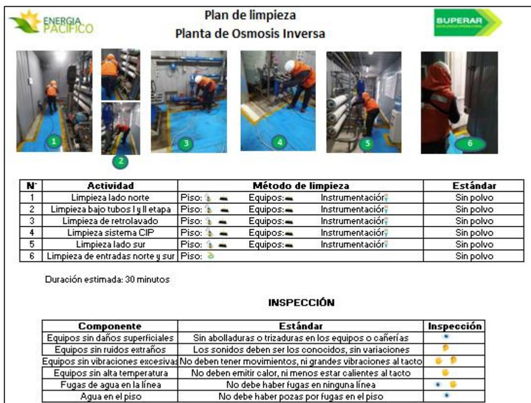
Figura 7.33: Plan de limpieza de la planta de osmosis inversa, presente en el cuadro de área de la planta.
