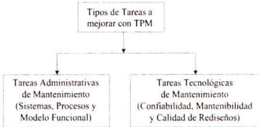
*Figura 4.4: Actividades básicas del mantenimiento en un proceso de TPM*
