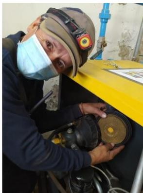
*Figura 7.15: Operador revisando el filtro de aire, identificando exceso de polvo en este.*
