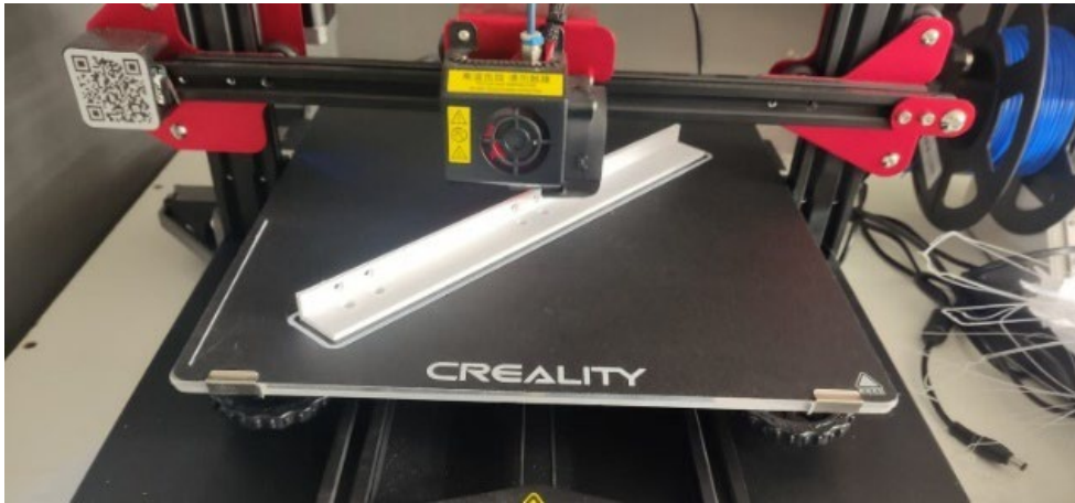
Figura 2-16 Impresión en progreso de la barra, de la maqueta "Barra y bola".
