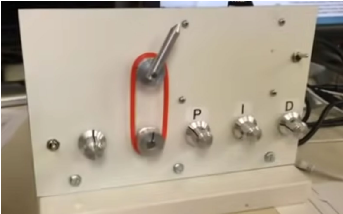
Figura 2-3 Maqueta control de posición: Demostración de control de un Servomotor.
