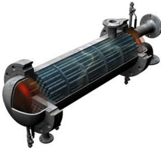
Figura 3-4: intercambiador de calor pirotubular
