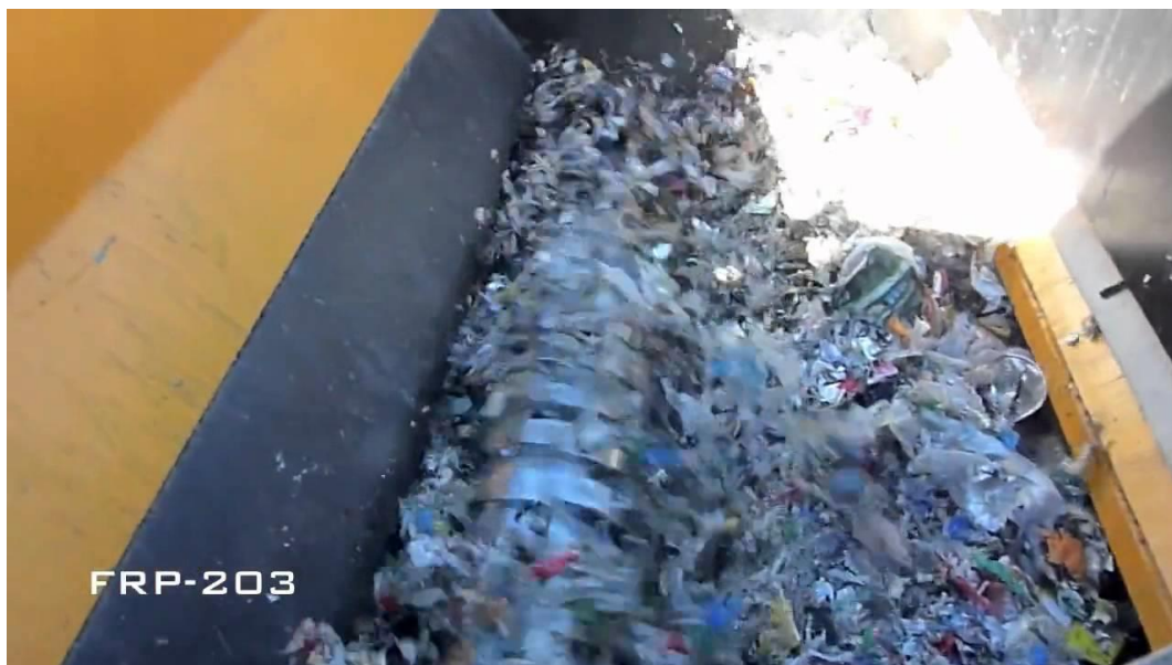
Figura 3-8: trituradora de residuos solidos urbanos
