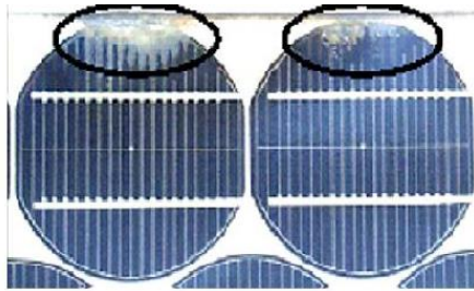
Figura 1.23 Delaminación en Módulo [39].
