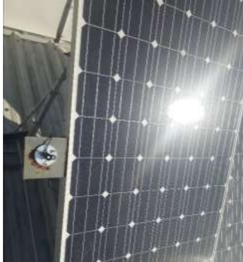
Figura 4.10 Piranómetro utilizado en panel PV con reflector.
