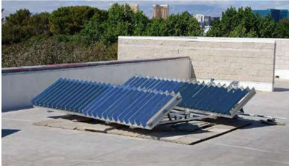
Figura 2.16 LCPV 3x Sun de JX Crystals, con seguidor de un eje [9].
