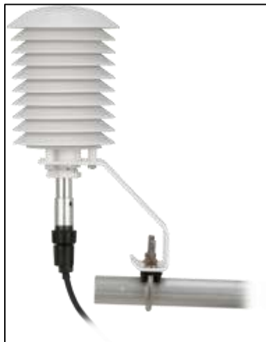
Figura 4.9 Sensor 083E-L empleado para las mediciones de temperatura ambiente en la estación meteorológica.
