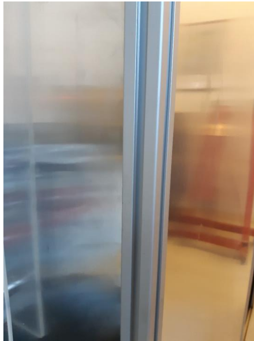
Figura 4-10: Plancha de aluminio de 3 mm adosada a perfil de aluminio T-slot.
