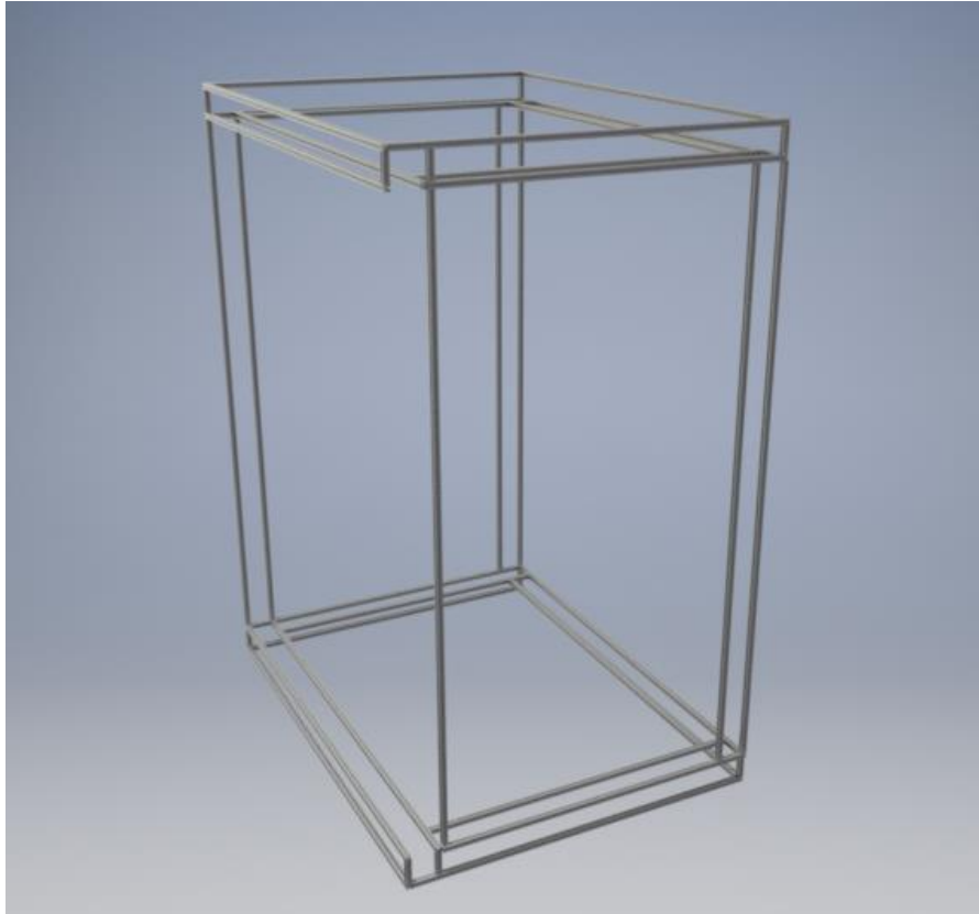
Figura 4-12: Modelo tridimensional del armazón de la cámara térmica.
