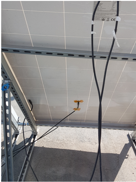
Figura 6-13: cara posterior del panel ensayado, se muestra la posición de los sensores
