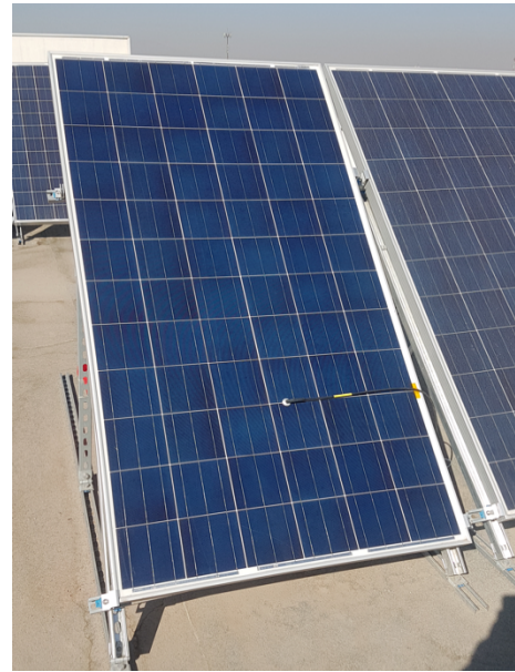
Figura 6-14: cara frontal del panel ensayado, se muestra la posición del sensor utilizado
