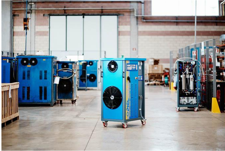
Figura 6: Unidad de baja y media capacidad de electrolizador McPhy, flujo de 0,4 a 12 Nm 3 /h y presión entre 1 y 8 bar.
