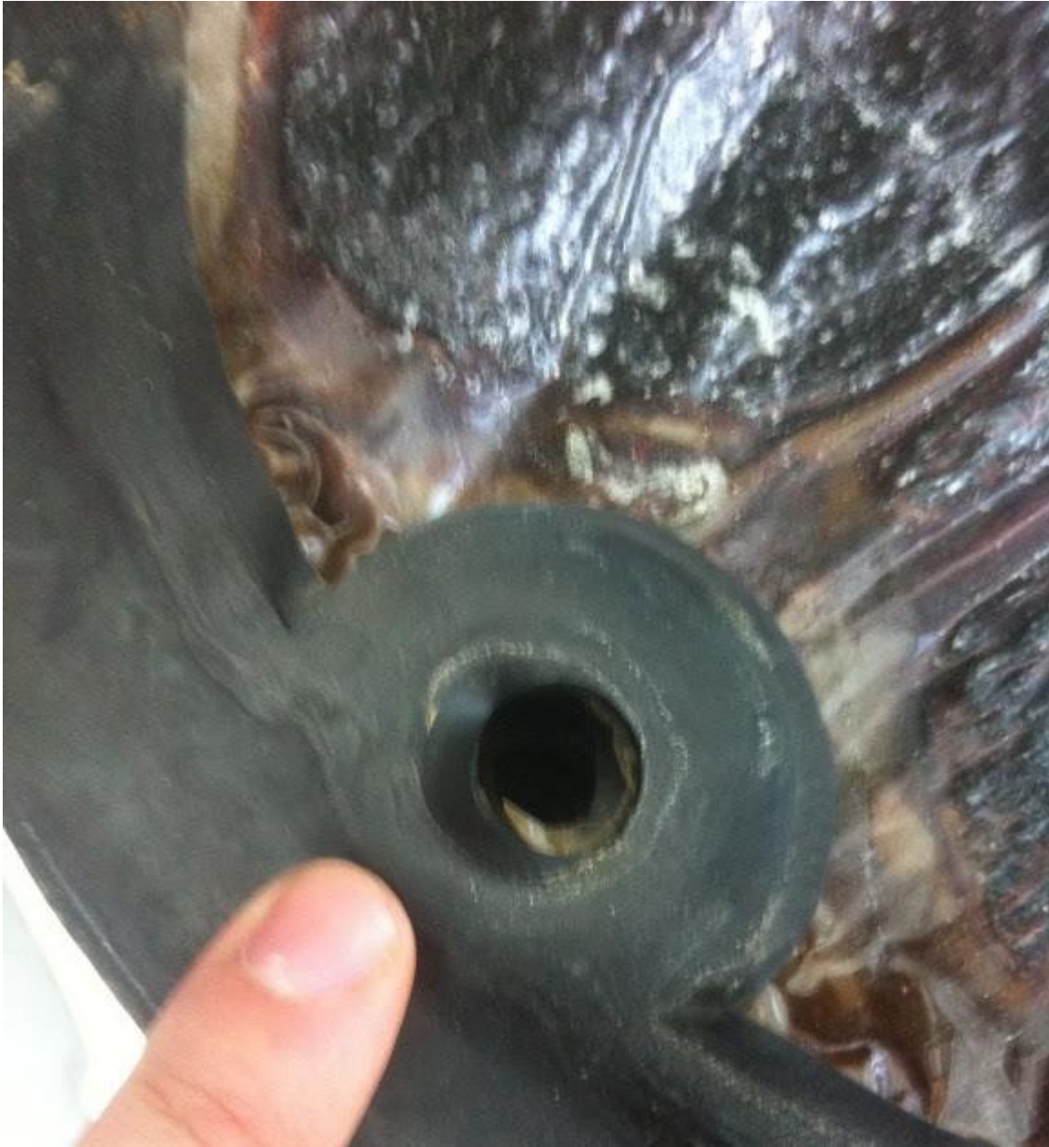
Figura 75: Membrana de intercambio protónico usada inicialmente en la construcción de la celda.
