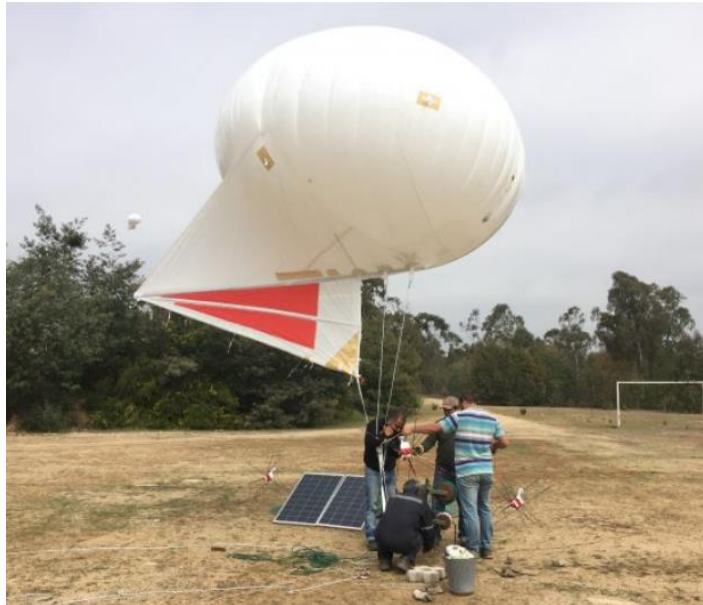
Figura 1: Globo relleno de hidrógeno para prospección del viento, propiedad de la Universidad Técnica Federico Santa María.
