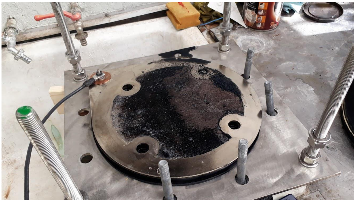
Figura 76: Restos de desintegración de empaque de goma en placa.
