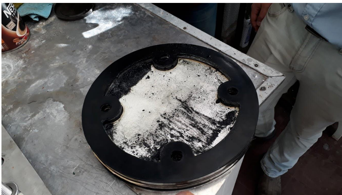
Figura 77: Restos de desintegración de empaque de goma en membrana.
