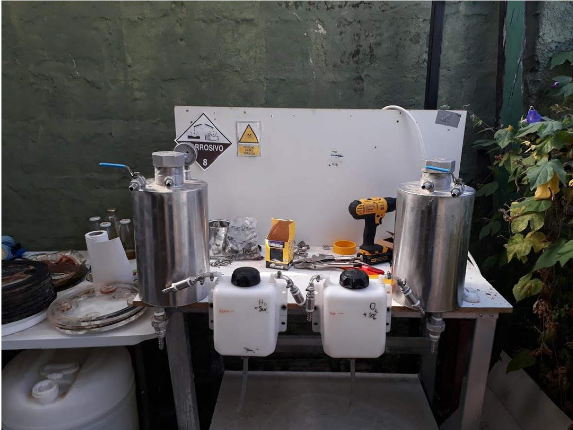
Figura 66: Montaje provisorio de estanques de acumulación.
