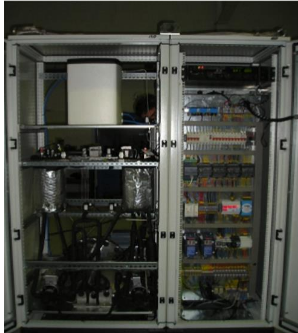
Figura 10: Electrolizador de Hidrógeno de Alta producción y baja presión, flujo de 0.25 a 1.2 Nm 3 /h con presión de 6 bar.
