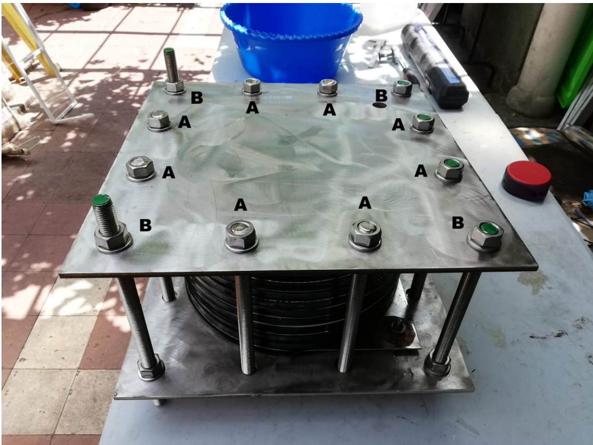
Figura 61: Celda completa ajustada con pernos en posiciones A (tracción) y B (compresión).
