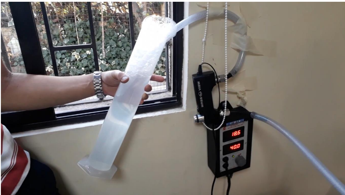
Figura 71: Salida de hidrógeno a presión ambiente en prueba de generación con celda completa.
