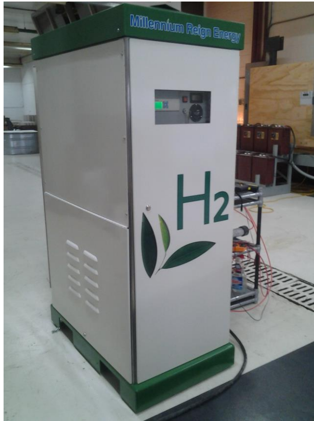
Figura 15: Electrolizador AutoARK® de 27 celdas, 0,46 Nm 3 /h.
