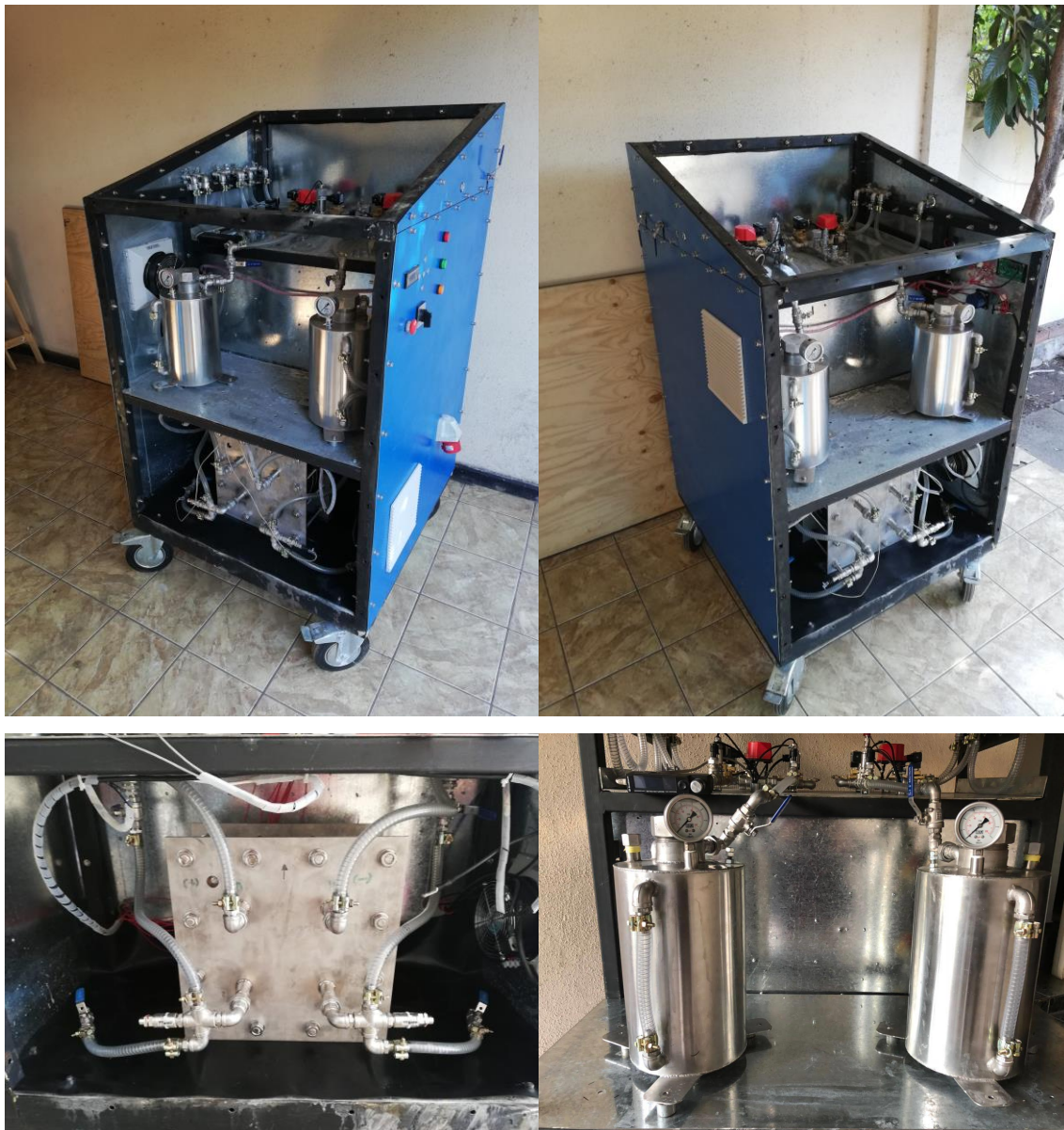
Figura 85: Equipo electrolizador construido y montado en estructura.
