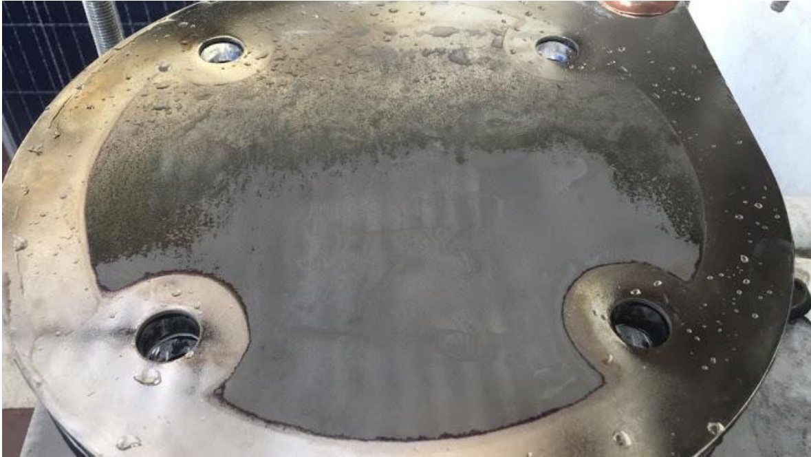
Figura 78: Placas polarizadas luego de utilizar agua desmineralizada para electrolito.
