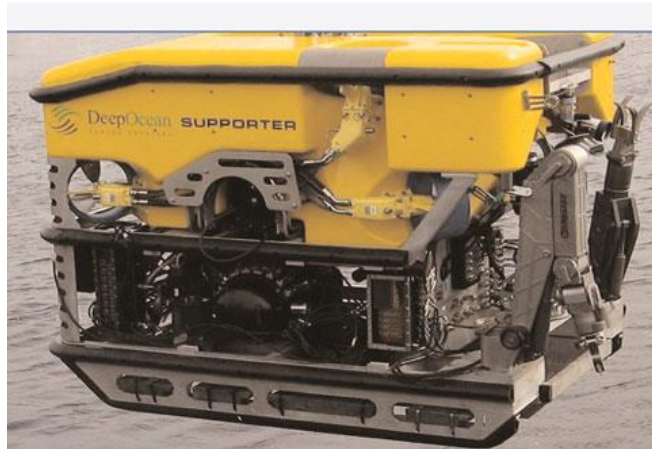
Figura 19. Sumergible para exploración subacuática, con dispositivos de flotabilidad y estructura de espuma sintáctica [34].
