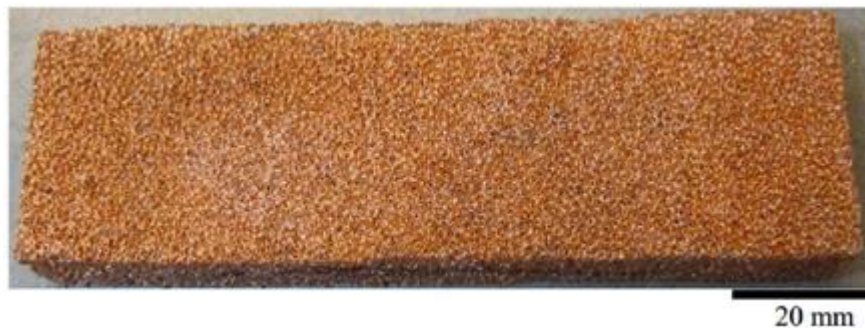
Figura 24. Espuma de cobre de celda abierta con una distribución de 10 poros por pulgada cuadrada [68].
