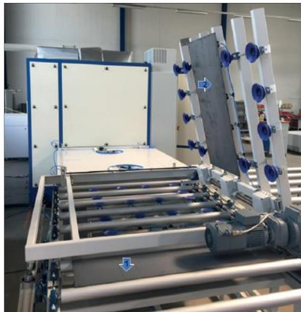
Figura 3.4 Sistema para separar vidrio en PF. [26]
