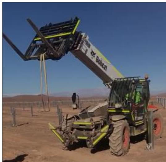
Figura 3.6 Manipulador telescópico Bobcat T35120SL.
