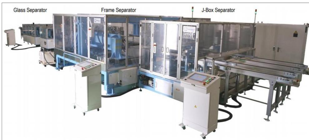
Figura 3.2 Línea automatizada para el reciclaje de PF, NPC Inc. [24]
