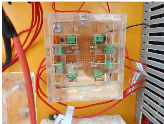
Figura 4.14: Divisor de tensión. Se energiza mediante cable de control y terminales de tornillo.
