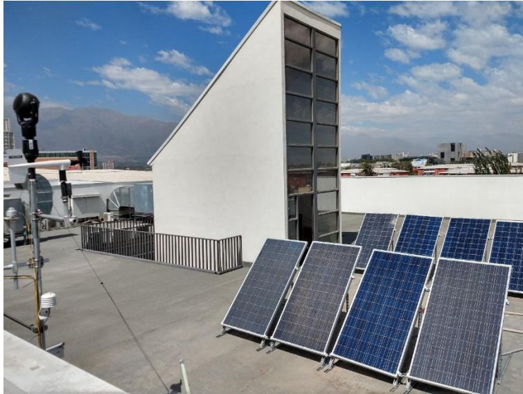
Figura 3.66: Disposición de ocho módulos FV de tecnología policristalina. Se observa que existen paneles que se mantienen limpios, mientras que otros módulos se ensucian de manera natural o inducida, a fin de comparar el comportamiento de los equipos.
