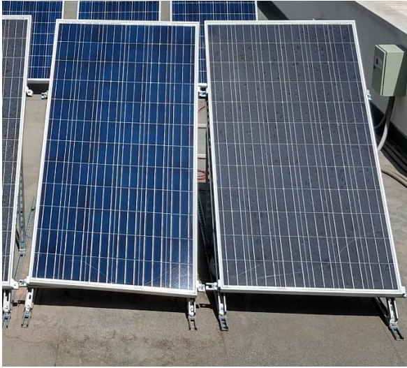
Figura 3.68: Ensuciamiento en los módulos. En la izquierda se observa el módulo 7 y 8 (ver Figura 3.50), donde el primero se limpia constantemente y el módulo 8 se encuentra sucio con soiling natural. En la figura derecha se encuentra el módulo 5, el cual se le añadió agua y residuos pegajosos para simular un ensuciamiento artificial.
