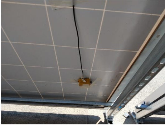
Figura 3.61: Medición de temperatura en la parte posterior del módulo mediante termistores.
