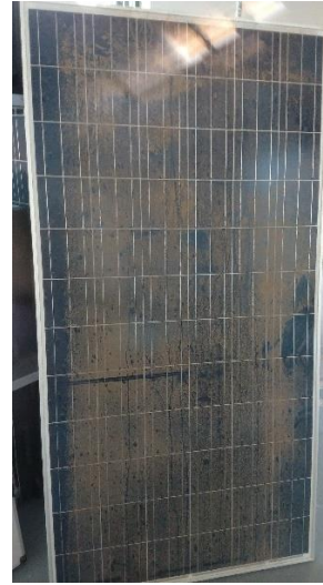
Figura 3.68: Ensuciamiento en los módulos. En la izquierda se observa el módulo 7 y 8 (ver Figura 3.50), donde el primero se limpia constantemente y el módulo 8 se encuentra sucio con soiling natural. En la figura derecha se encuentra el módulo 5, el cual se le añadió agua y residuos pegajosos para simular un ensuciamiento artificial.
