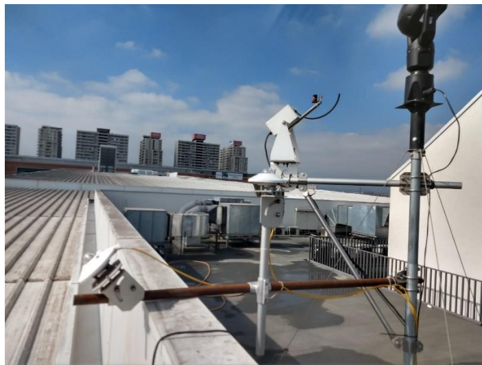
Figura 3.64: Reubicación de la estación meteorológica hacia el lado norte de la azotea del edificio F. Instalación de la cámara térmica fija MIC 612 en lo más alto de la estación meteorológica.
