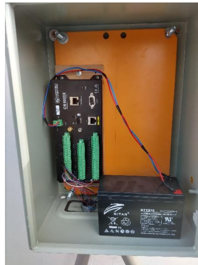
Figura 3.70: Se instala una caja metálica al oeste de la azotea, destinada sólo a proteger un registrador de datos CR1000X, el cual se encuentra almacenando información de los sensores de temperatura.
