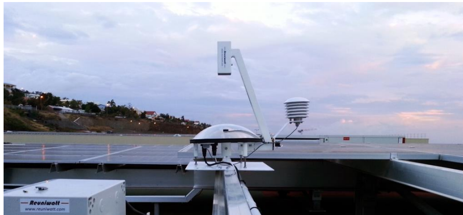
Figura 2.6: Cámara para la adquisición de imágenes de cielo “Sky InSight”, de Reuniwatt [22].
