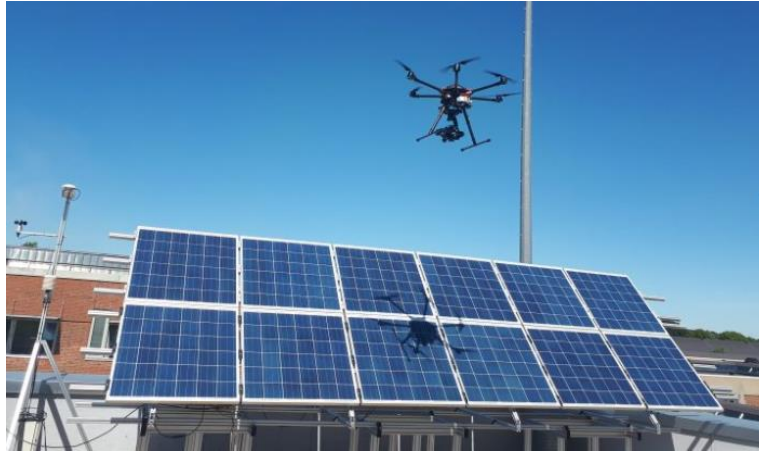
Figura 2.1: Uso de drone para la inspección por electroluminiscencia y fotoluminiscencia en el proyecto DronEL [20].
