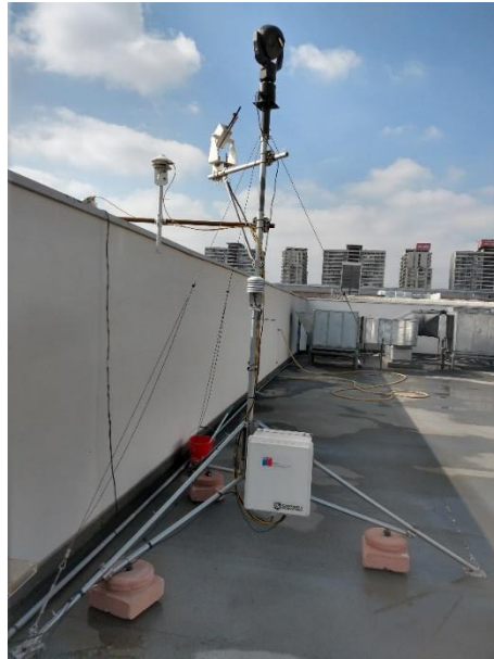
Figura 3.64: Reubicación de la estación meteorológica hacia el lado norte de la azotea del edificio F. Instalación de la cámara térmica fija MIC 612 en lo más alto de la estación meteorológica.
