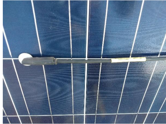
Figura 3.71: Conexión sensores de temperatura PT1000. Se encuentran montadas de manera continua en la parte posterior del módulo (imagen izquierda) en los módulos 3, 4, 7 y 8 (ver Figura 3.50). Se han realizado experimentaciones en las que se requiere medición en la parte frontal (imagen derecha), para luego volver al sector posterior.
