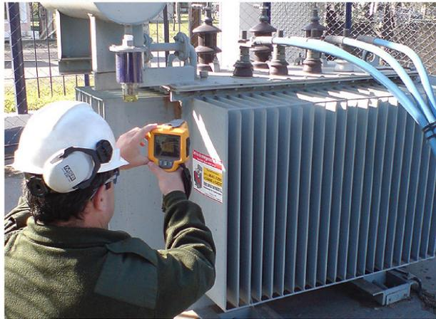
**Figura 3.5:** Ejecución de análisis termográfico a transformadores.
