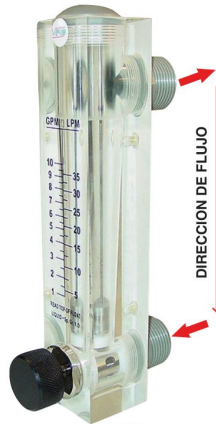
Figura 4.11: Rotámetro instalado en la línea de alimentación de agua salada del Humidificador [34].
