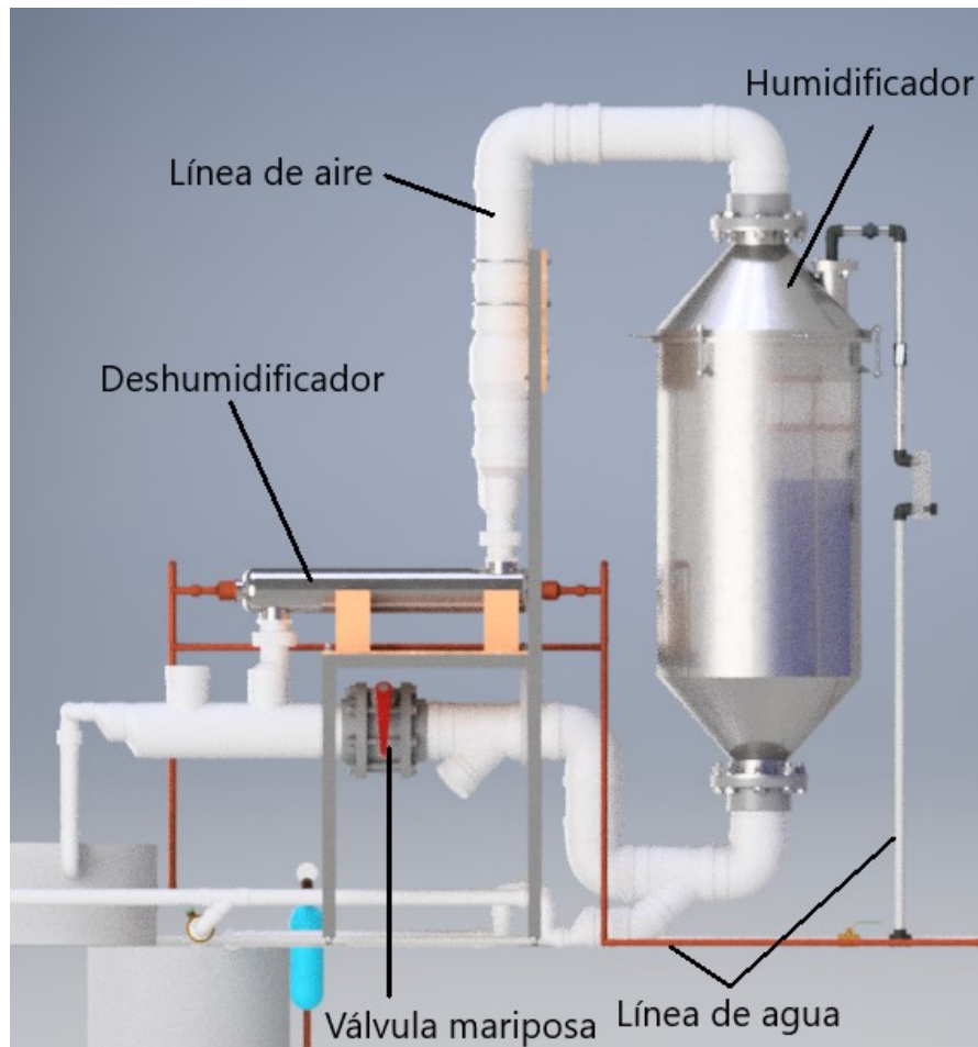
Figura 6.3: Sistema de humidificador-deshumidificador.
