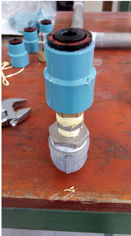
Figura 4.6: Instalación de aspersores para riego de jardín como sustituto de easpersores de humidificación.
