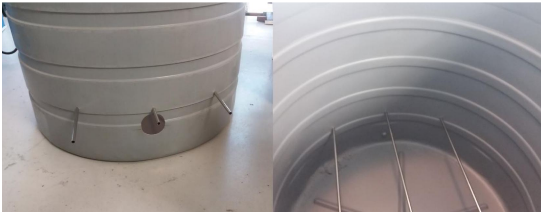
Figura 3.5: Perforación para ducto de 6 pulgadas de entrada de aire y soportes de relleno evaporativo. Fuente [28].
