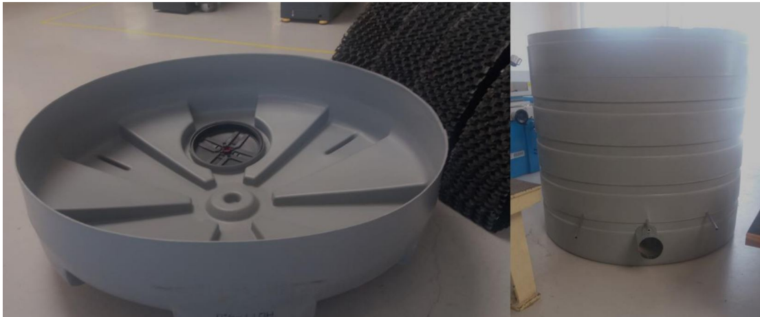
Figura 3.4: Corte realizado al tanque para generar una tapa desmontable. En la imagen de la derecha se aprecian los tubos de 20[mm] que actúan como base para el relleno evaporativo y la entrada del aire a través del tubo de 6 pulgadas. Fuente [28].
