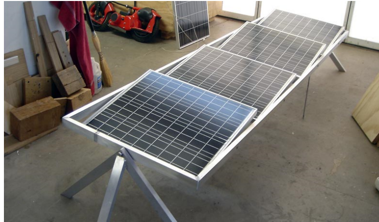
Figura 2.6: Seguidor solar de dos ejes Horizontales. Fuente: Pepperl+Fuchs.
