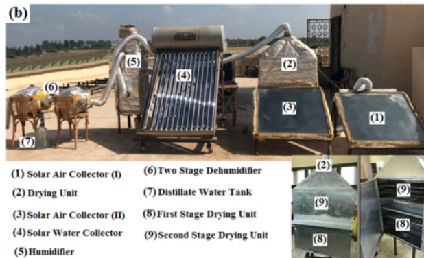
Figura 2.18: Esquema de sistema HDH con calentamiento de aire mediante deshidratadores solares [17].
