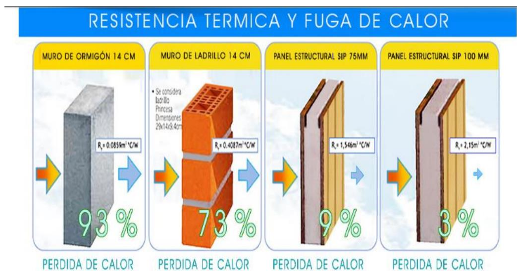
Ilustración 60 Resistencia Térmica y fuga de calor
