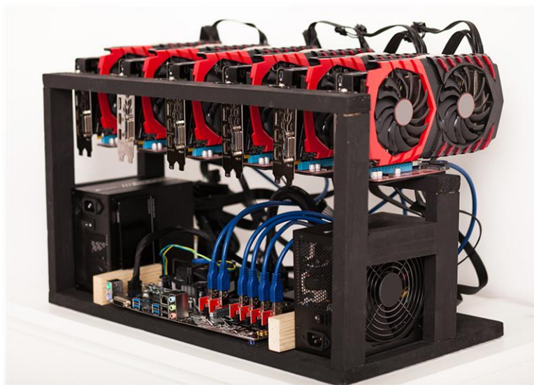
Figura A.2.3: Nodo minero tipo GPU, modelo “AMD Rig 6 Vga RX470”. Puede minar 14 algoritmos distintos a una tasa máxima de 156MH/s, consumiendo 720W de potencia [48].
