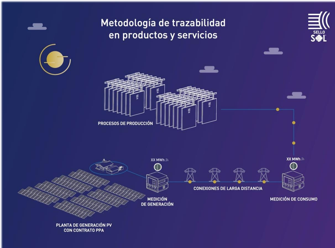
Figura A.3.10: Esquema de medición y captura de datos de energía eléctrica de acuerdo con la iniciativa Sello Sol [24].
