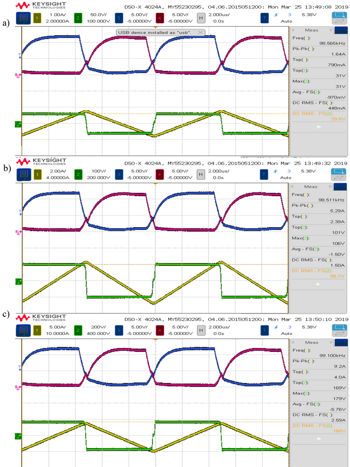
Figura 3.15, Carga inductiva de 98uH. Voltaje de entrada de: (a) 30V, (b) 100V, (c) 170V.
